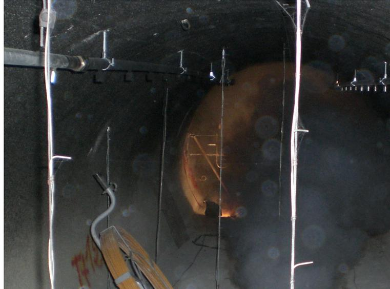
FIG. III.12 – Vue de la fixation des thermocouples
