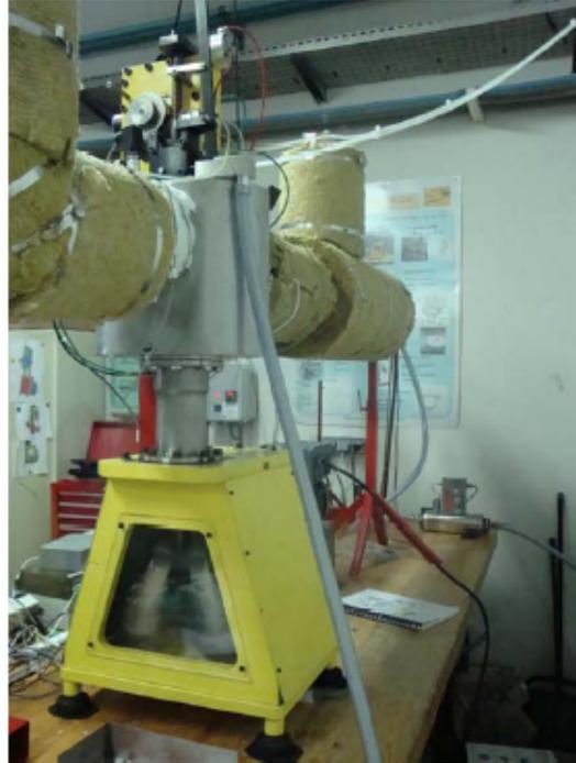
FIGURE 4.3 – *Vue d'ensemble du prototype de la partie chaude du moteur Ericsson*
