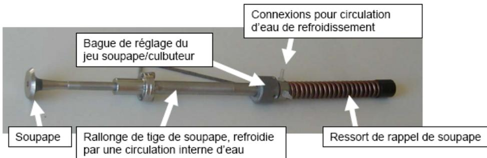
FIGURE 4.8 – *Soupape et sa rallonge de tige refroidie à l'eau*
