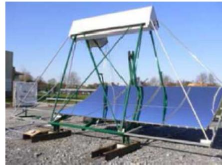
FIGURE 4.2 – Concentrateur solaire utilisé dans l'étude [29]
