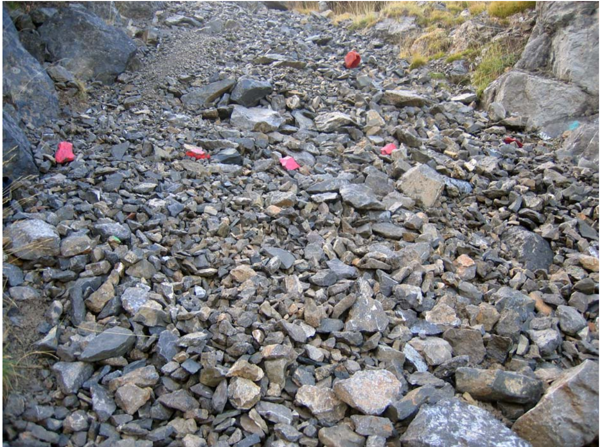
Figure 4.5 – Cinq petits blocs peints alignés perpendiculairement à la pente dans la zone proximale du cône d'éboulis de Cadi. Une fois par an, les blocs sont replacés sur leur position d'origine grâce à la corde graduée tendue entre les deux rochers.
