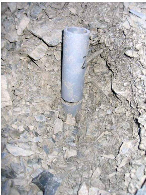
Figure 4.6 – Colonne de segments de tube PVC dans la couche superficielle du cône d'éboulis de Péric. Seuls deux tubes ont pu être enfoncés.
