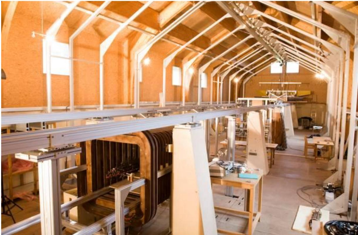
figure 29. Le bâtiment principal du LMMCF, dédié aux mesures. Il est orienté dans la direction Nord-Sud. On distingue au premier plan les rails sur lesquels sont fixées les maquettes. L'ossature en aluminium contient les bobines qui permettent le contrôle du champ ambiant selon les 3 directions.
