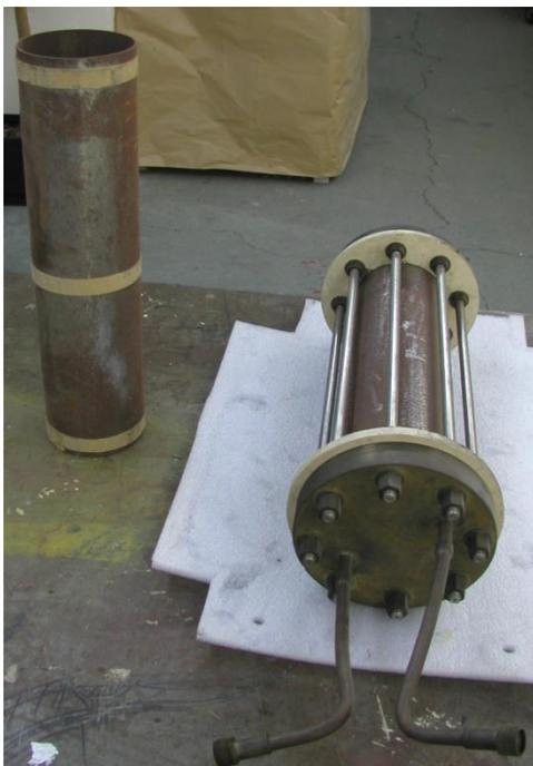
figure 30. Le cylindre seul, puis présenté avec le système de flasques.
