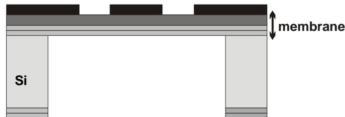
**Figure II.10. Topologie de la ligne CPW sur membrane**
