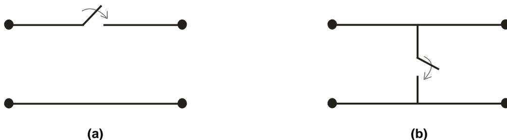
Figure IV.1. Schéma illustrant un commutateur placé dans une configuration (a) séries ou (b) parallèle
