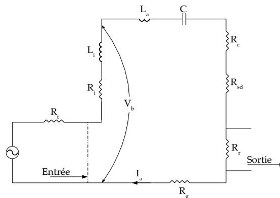
Figure I.12 Circuit électrique équivalent d'un émetteur VLF
