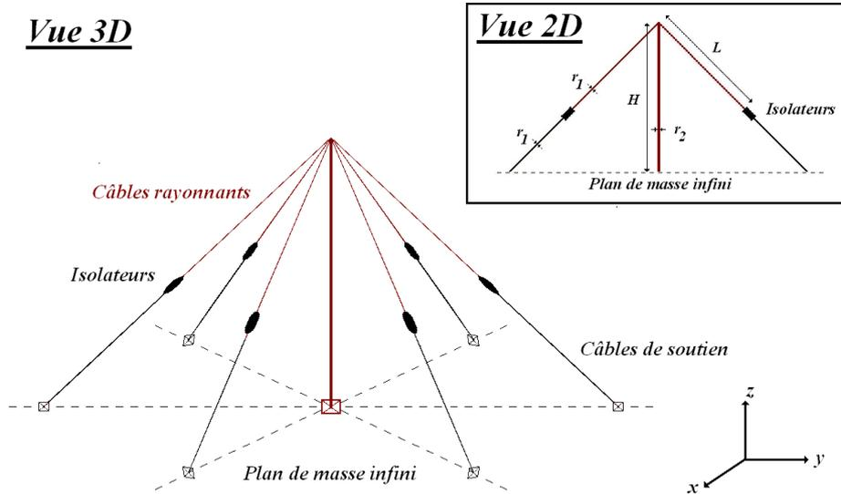
**Figure IV.32 :** Antennes parapluie avec 6 bras
