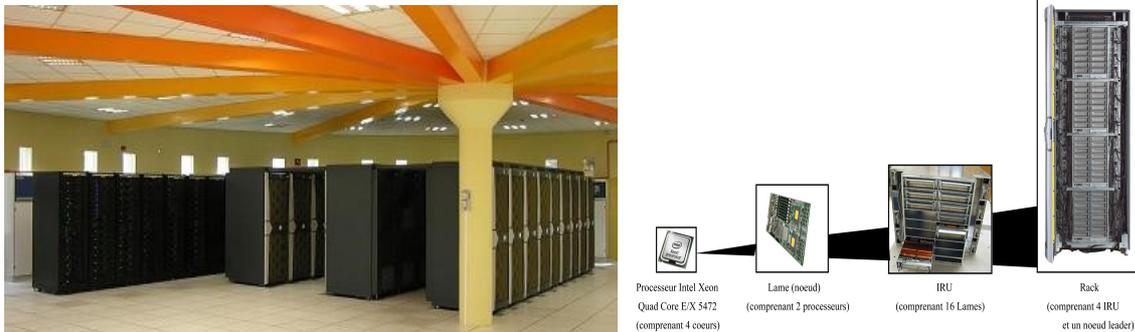
*Figure 1.26 La machine SGI ALTIX ICE du CINES et son architecture*
