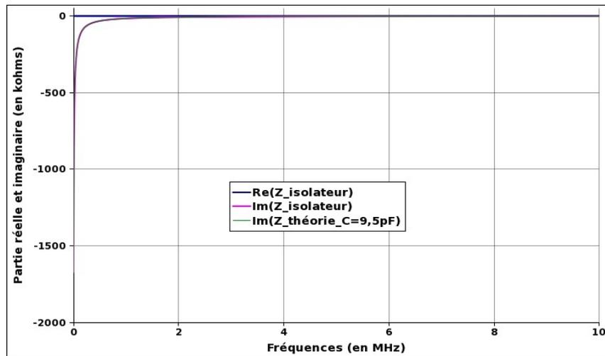
*Figure II.20 : Partie réelle et imaginaire de l'impédance de l'isolateur entre 0 et 10 MHz*
