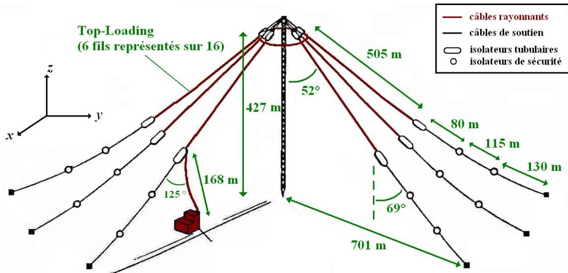
Figure IV.46 : Structure de l'antenne « E » du système OMEGA
