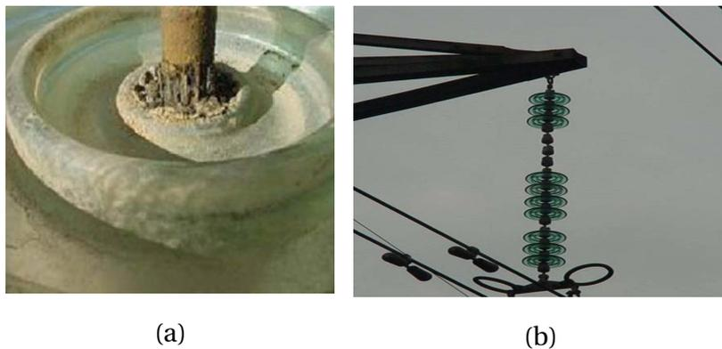
**Figure II.4 :** *Isolateurs : Corrosion (a) et Vandalisme (b)*
