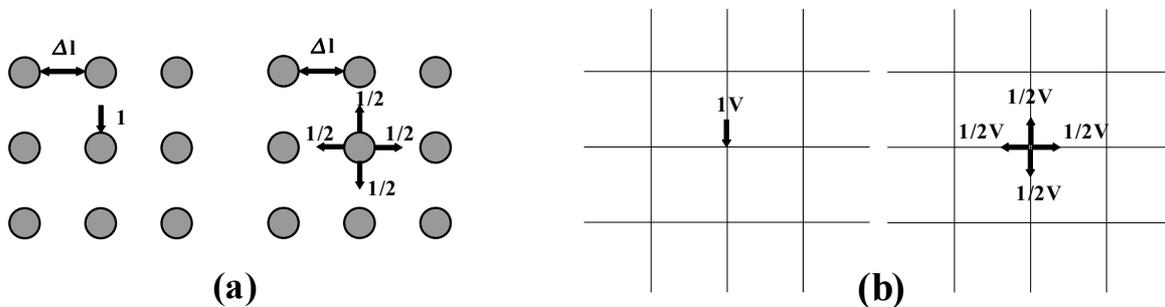
Figure I.20 Propagation des impulsions dans un réseau 2D : (a)Principe discret de Huygens
