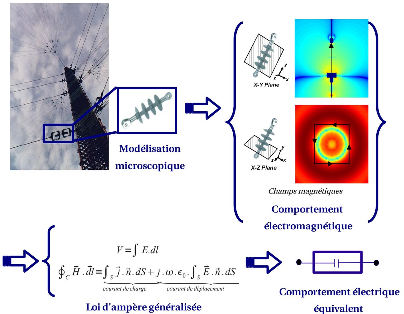
Figure II.13 : Principe de la caractérisation électrique
