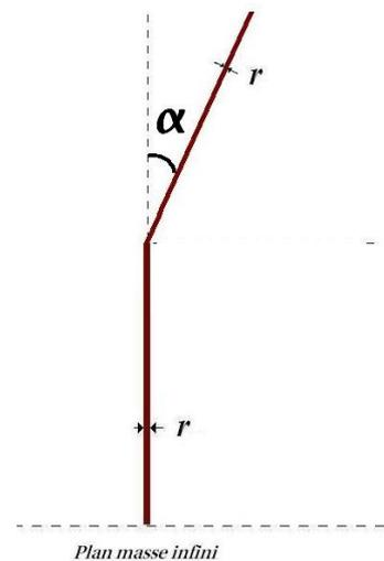
*Figure IV.34 : Antenne L-inversée*
