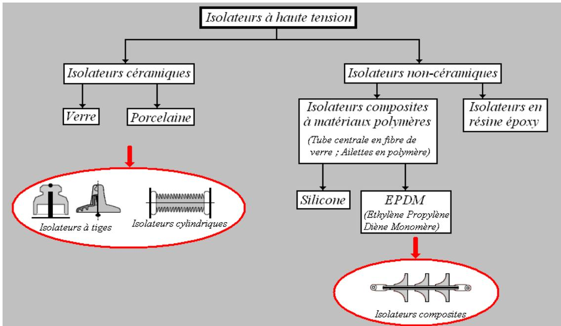
Figure II.3 Classification des différents types d'isolateurs
