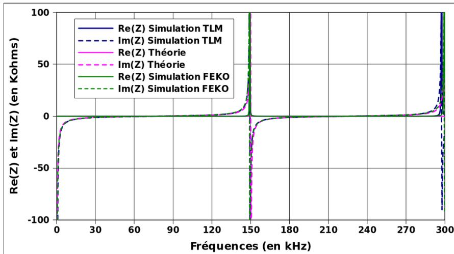
Figure III.12 : Parties réelle et imaginaire de l'impédance d'entrée au niveau du générateur
