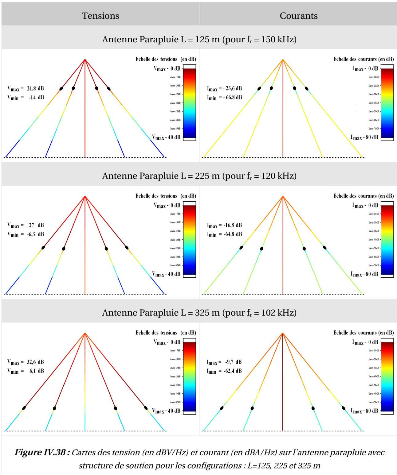
Avec les structures de soutien, les niveaux de tension et courant sont moins élevés sur les configurations « L125 » et « L225 ». La configuration « L325 » ne semble pas être affectée.
