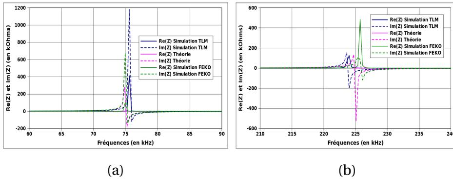
Figure III.10 : Parties réelle et imaginaire de l'impédance d'entrée au niveau du générateur : au voisinage des fréquences  $f = 75$  kHz et  $f = 225$  kHz
