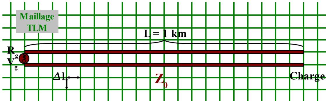
Figure III.11 : Ligne bifilaire chargée par un circuit-ouvert
