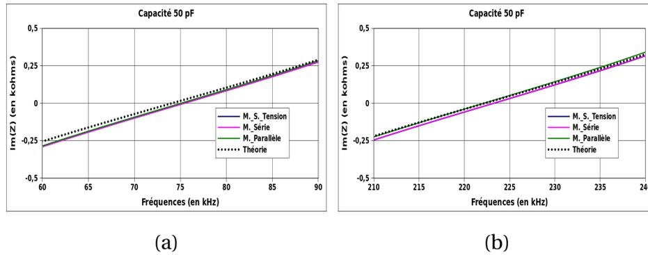
*Figure III.19 : Partie imaginaire de l'impédance ramenée au niveau du générateur : au voisinage des fréquences  $f = 75$  kHz (a) et  $f = 225$  kHz (b)*
