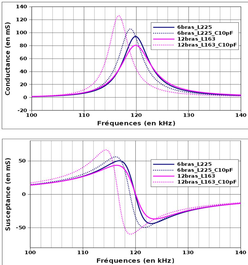
*Figure IV.42 : Comparaison des résultats de simulation TLM au niveau de la Conductance et de la susceptance pour les deux antennes avec et sans structure de soutien*
