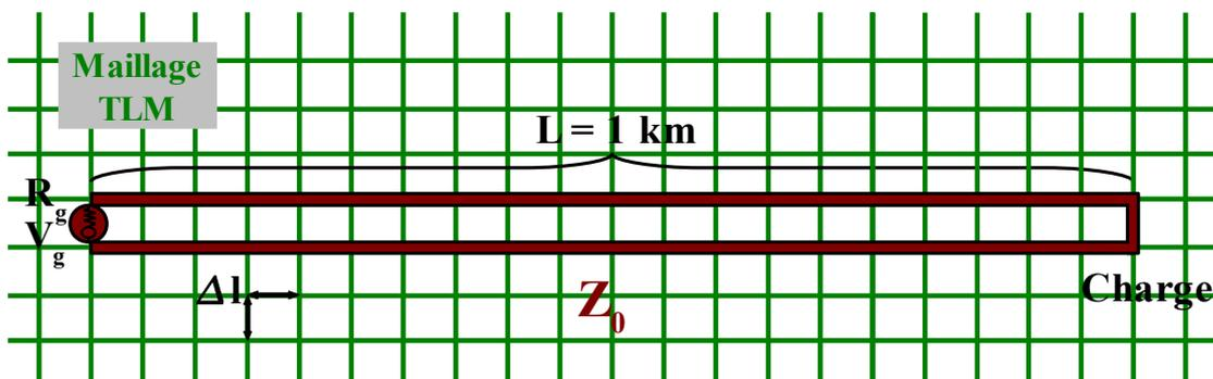
Figure III.7 : Ligne bifilaire chargée par un court-circuit
