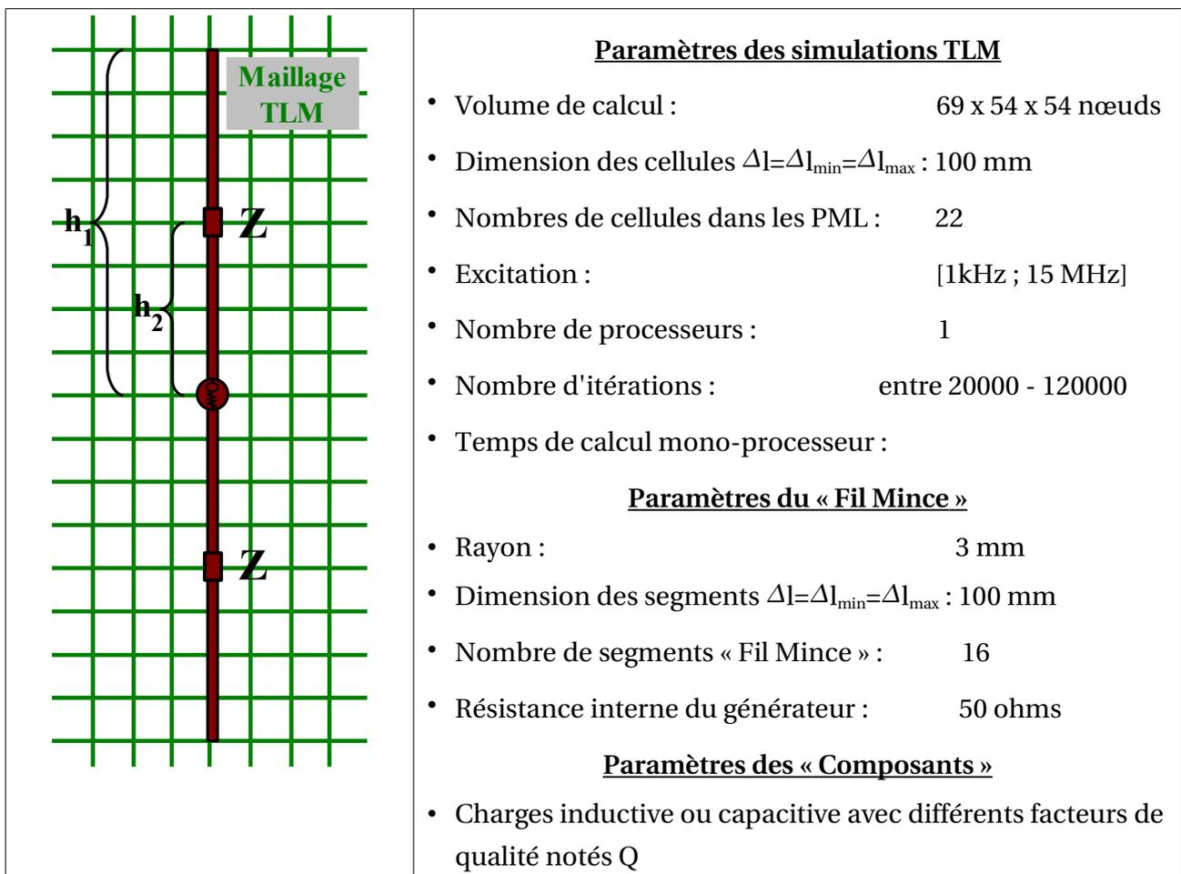
Figure III.25 Paramètres de simulation du dipôle chargé
