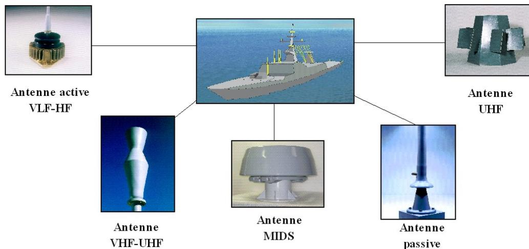
*Figure I.4 Antennes des bâtiments de surface*
