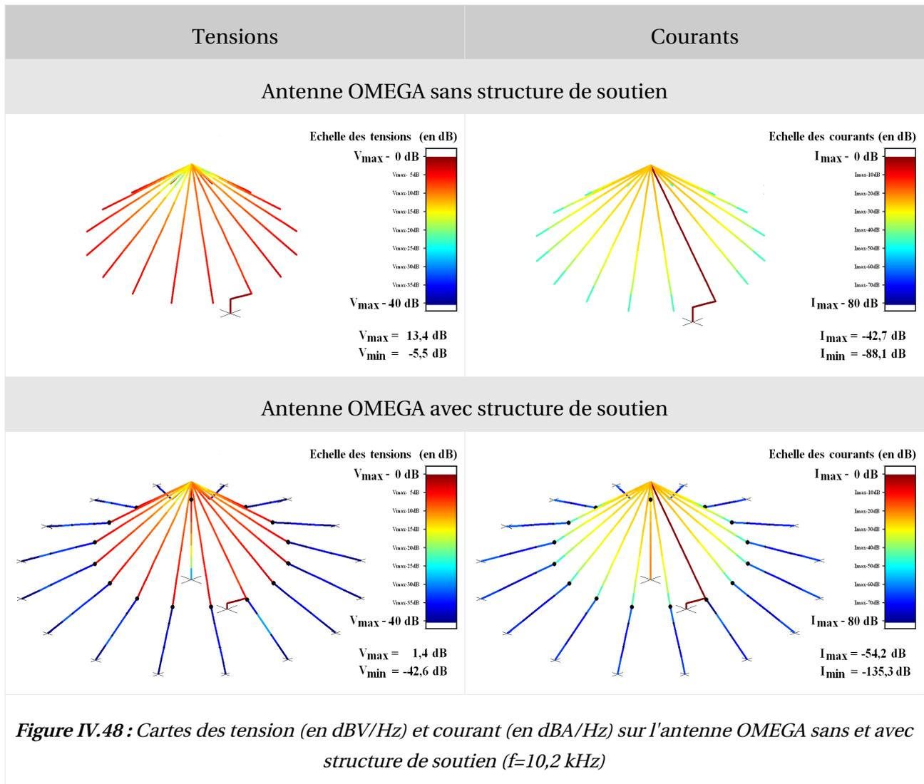
La tour de soutien est parcourue par des courants de fuite relativement importants : de l'ordre de -20 dB par rapport au courant maximal. La tension est également élevée au sommet de la tour. Cette tour, non isolée du plan de sol, participe activement à la détérioration de l'efficacité de l'antenne.
