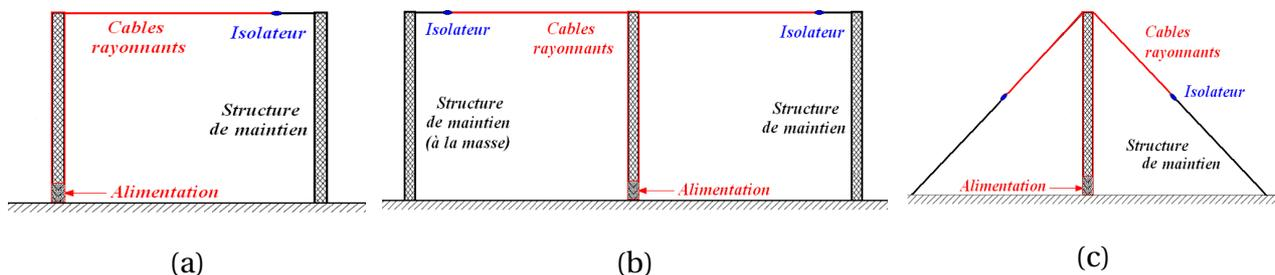
**Figure I.14** Top-Loading : (a) Antenne L-inversée, (b) Antenne en T, (c) Antenne Parapluie
