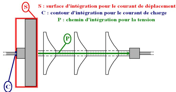
Figure II.19 : Isolateur : Chemin, Contour et Surface d'intégration
