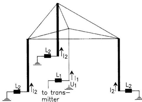
**Figure I.15** Antenne Goliath simplifiée : trois mâts sont reliés à la masse à travers trois bobines d'accord. Le top-loading commun aux trois mâts est alimenté en son centre
