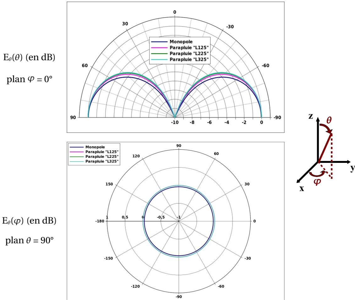
Figure IV.40 : Diagrammes de rayonnement : champ normalisé  $E_\theta$  en dB suivant les plans  $\phi = 0^\circ$  et  $\theta = 90^\circ$
