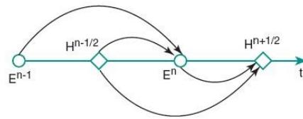
Figure I.18 Modèle « saute mouton » de discrétisation temporelle
