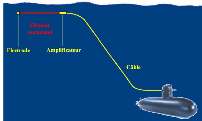
Figure I.7 Antenne Filaire
