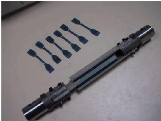
Figure E.1 – Éprouvettes de traction et de double cisaillement.
