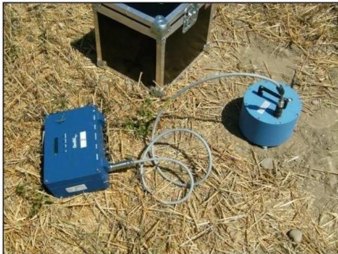
Figure 62: Dispositif de mesure H/V : Vélocimètre à droite et boîtier d'acquisition à gauche.
