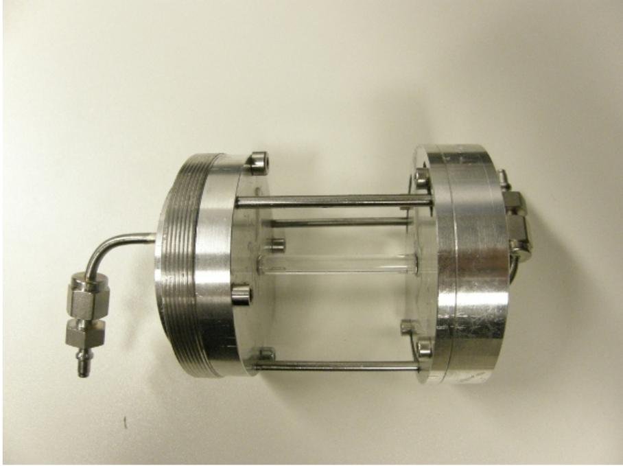
FIGURE 2.3 – Capillaire monté et collé dans son porte-capillaire étanche et extensible.
