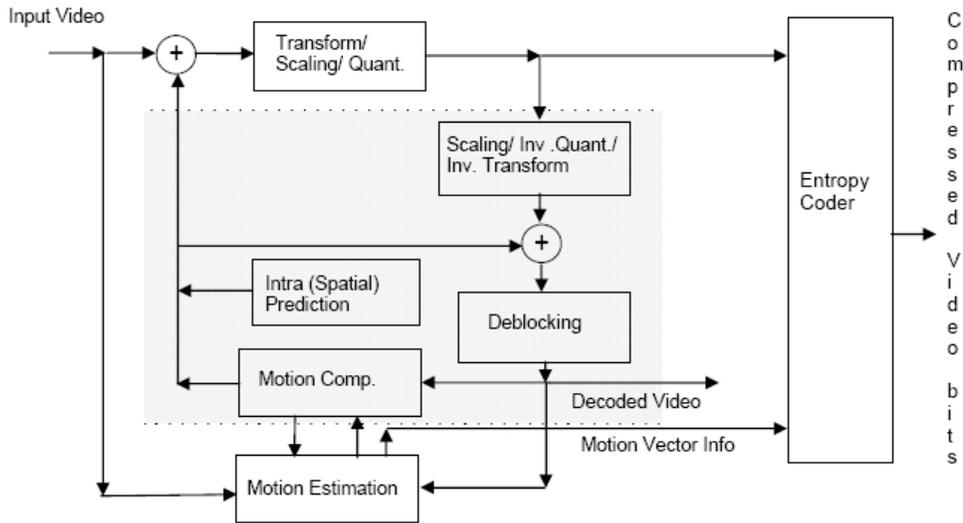
FIG. 1.7 – Schéma fonctionnel du codage H.264/AVC [Sul04].
