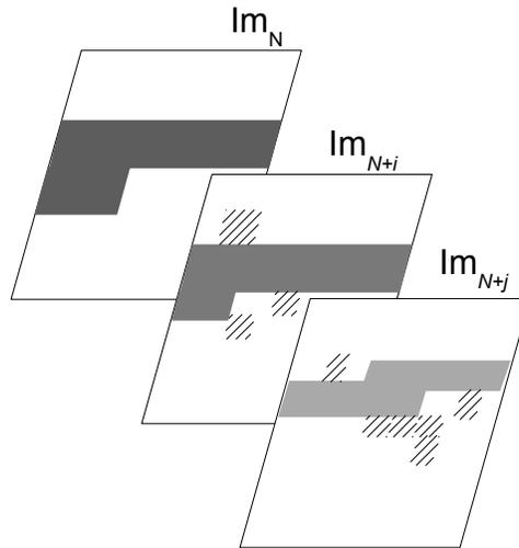
FIG. 1.9 – Un exemple de slice perdue (image  $Im_N$ ) et de la propagation spatio-temporelle qui s'en suit (images  $Im_{N+i}$  et  $Im_{N+j}$ ). La slice perdue et les slices affectées par cette perte sont respectivement colorées en noir et gris. La couleur grise est nuancée pour marquer l'atténuation de l'effet de perte avec la distance temporelle par rapport à la perte. Les macroblochs hachurés représentent la propagation spatiale de la perte.
