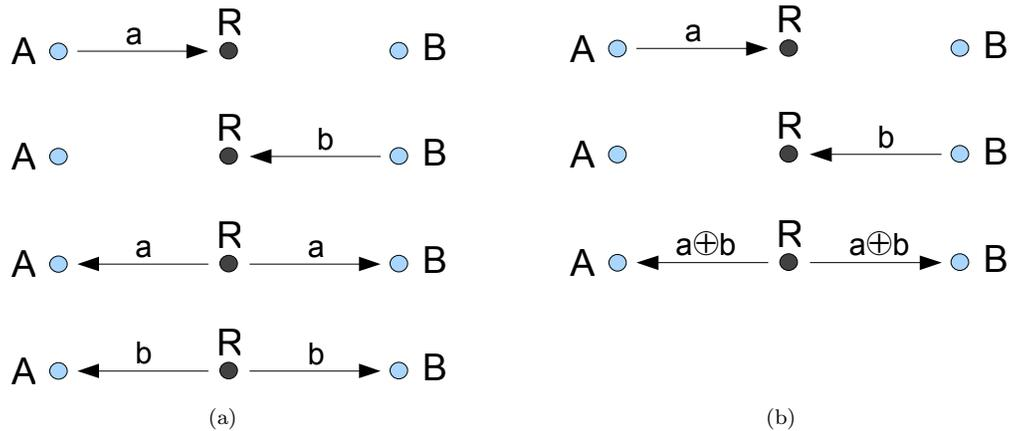
FIG. 2.1 – Diffusion d'informations radios (a) sans codage réseau et (b) avec codage réseau.  $A$  (respectivement  $B$ ) veut envoyer un message  $a$  (resp.  $b$ ) à  $B$  (resp.  $A$ ) à travers le nœud relais  $R$ . Trois diffusions sont nécessaires au lieu de 4 quand le codage réseau est utilisé.
