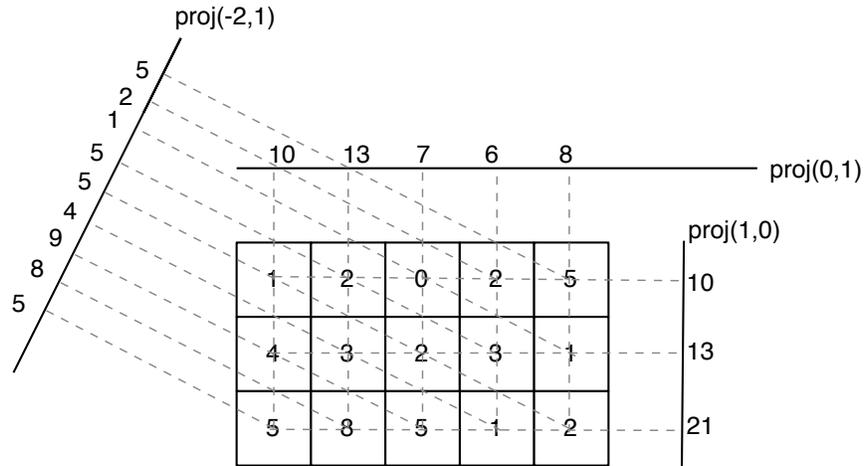
FIG. 3.3 – Trois projections Mojette d'un support de données  $5 \times 3$  :  $(-2, 1)$ ,  $(0, 1)$  et  $(1, 0)$ . Cet ensemble de projections ne suffit pas à la reconstruction du support 2D à partir des projections 1D car ne satisfaisant pas au critère de Katz.
