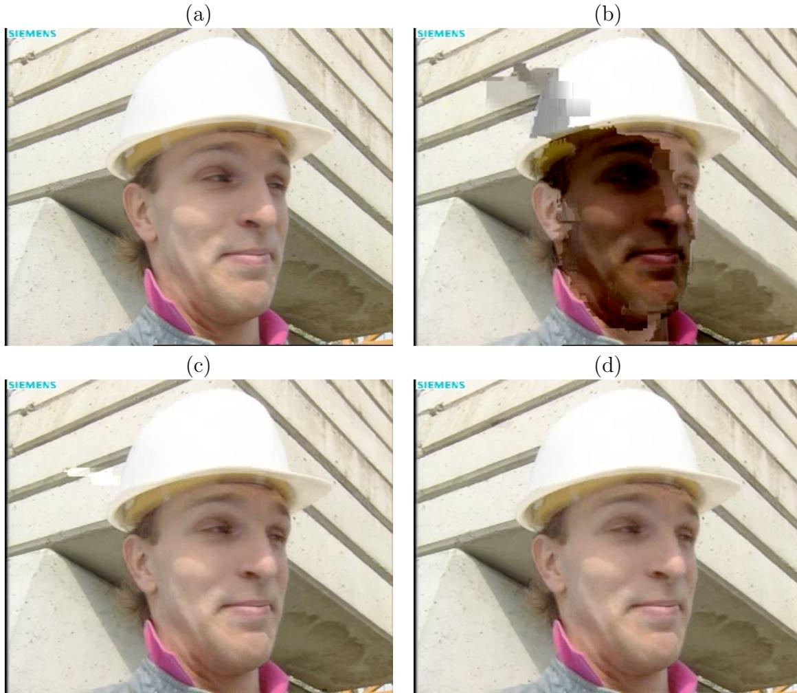
FIG. 3.15 – Qualité de la 5-ième image de *Foreman.cif* obtenue après (a) un décodage sans erreur, (b) un décodage *standard*, (c) un décodage *robust*, et (d) un décodage *CRC-robust* pour un SNR de 2.8 dB, lors d'une transmission avec codage canal
