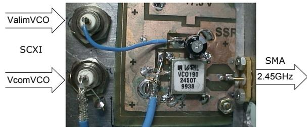
Figure 11 : Implantation du VCO d'injection
