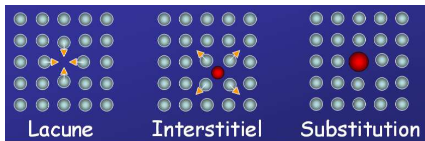
FIGURE 2.1 – Les trois scénarios possibles pour un défaut de dimension 0 : lacune (un atome manquant), interstitiel (un atome supplémentaire) et substitution (un atome d'espèce chimique différente à la place d'un atome de la structure).
