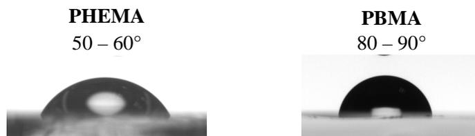
**Figure 127** – Angles de contact de films de PHEMA et PBMA
