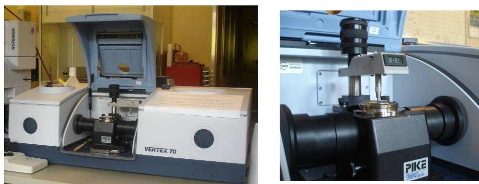
**Figure 154** – Appareil IR – ATR Bruker Vertex 70 avec platine miracle Pike composée du cristal ATR
