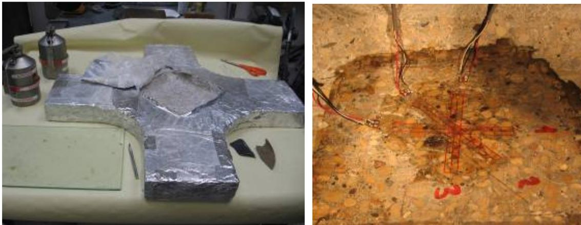
**Figure 208 : Collage des jauges : préparation et résultat**
