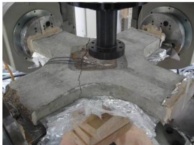
**Figure 213 : Rupture de l'éprouvette (déballée après l'essai).**
