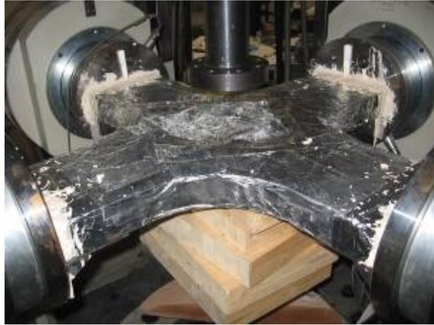
**Figure 212 : Epreuve collée et testée en conditions endogènes.**
