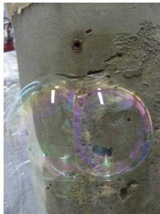
**Figure 60 : Mise en évidence de la fuite d'air injecté, par la fissure.**
