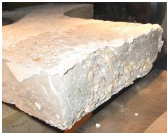
**Figure 211 : Bras de l'éprouvette décollé.**
