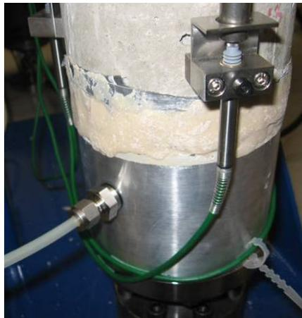
Figure 74 : Dispositif d'injection de gaz dans l'éprouvette.
