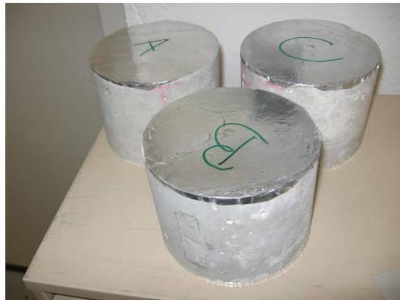
**Figure 82 : Epreuves de mesure de la perte de masse.**
