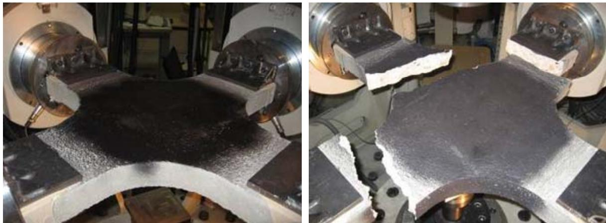
**Figure 205 : Test avec une éprouvette non usinée.**
