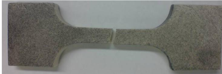
**Figure 64 : Rupture de l'éprouvette.**
