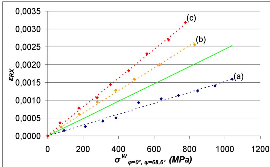
FIG. III.25 – Évolution des déformations élastiques mesurées par diffraction des rayons X  $\epsilon_{RX}$  dans la direction ( $\phi = 0^\circ$   $\psi = 68,6^\circ$ ) en fonction de la contrainte appliquée dans le tungstène, pour les différents échantillons à dispersoïdes de cuivre : (a) W/Cu 12/0,5, (b) W/Cu 3/0,5 et (c) W/Cu 1,5/0,5. La contrainte dans le tungstène est évaluée par le modèle de Mori-Tanaka et les constantes d'élasticité sont celles du tungstène massif.
