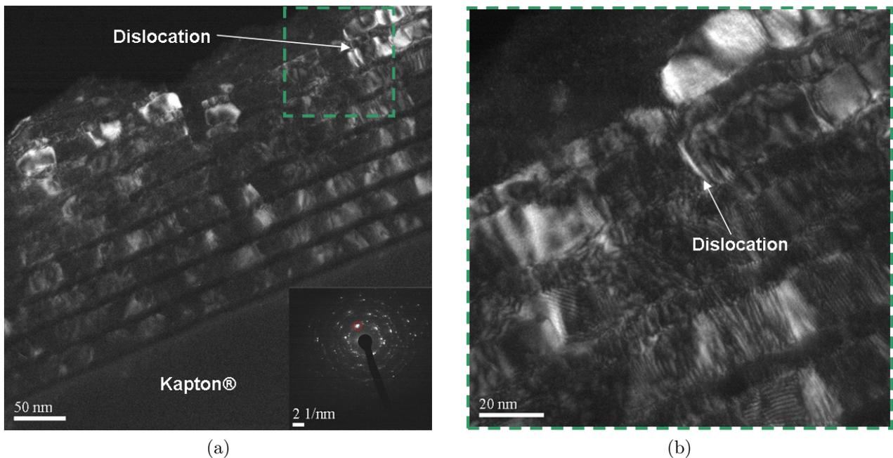
FIG. IV.40 – Images en champ sombre du film mince W/Cu 6/18 MP à différents grossissements, réalisées avec de la tache  $\{111\}$  du cuivre correspondant aux plans orientés selon la direction de croissance.
