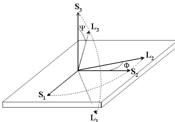
FIG. II.6 – Définition des angles  $\psi$  et  $\phi$ .
