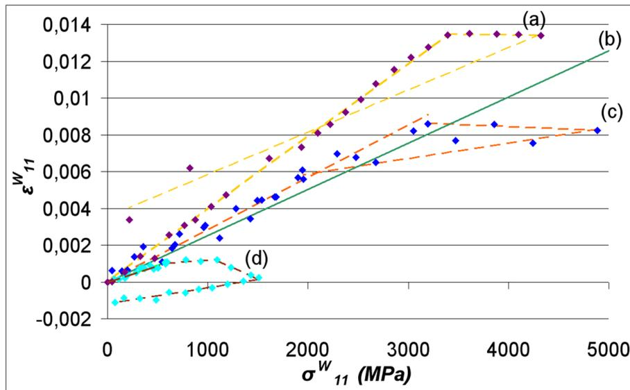
FIG. IV.25 – Évolution de la déformation élastique au sein des couches de tungstène selon l'axe de traction  $\epsilon_{11}^W$  ( $\phi=0^\circ$ ,  $\psi=90^\circ$ ) des trois composites lamellaires W/Cu 6/18 (a) MP, (c) I et (d) M en fonction de la contrainte appliquée dans le tungstène selon l'axe de traction  $\sigma_{11}^W$ . La droite verte (b) représente la déformation calculée par homogénéisation.
