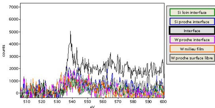
FIG. B.12 – Diagrammes EELS réalisés du substrat de silicium vers la surface du film W/W 1/1.
