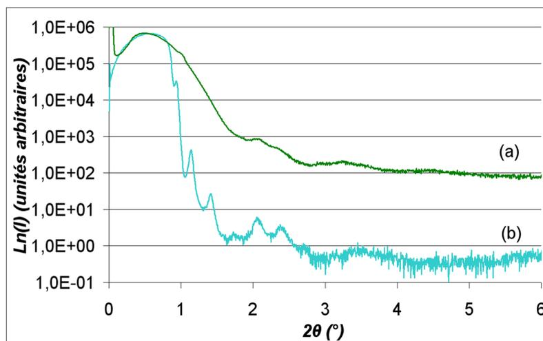
FIG. IV.9 – Diffractogrammes de réflectométrie de l'échantillon W/Cu 6/18 M réalisés sur substrat (a) de Kapton<sup>®</sup> et (b) de silicium.
