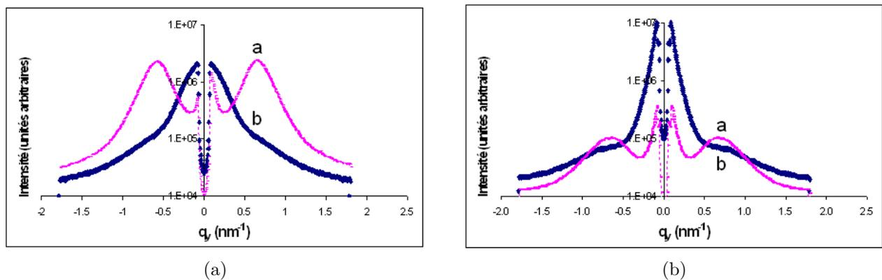
FIG. A.3 – Coupes verticales des diagrammes de diffusion 2D à  $q_z = 1,72\text{ nm}^{-1}$  pour W15 (a) et  $1,29\text{ nm}^{-1}$  pour W120 (b). a :  $1$  et b :  $0,5\text{ nm}$  Cu. Les courbes associées aux échantillons présentant  $3\text{ nm}$  d'épaisseur de tungstène (W30) sont données au chapitre III.
