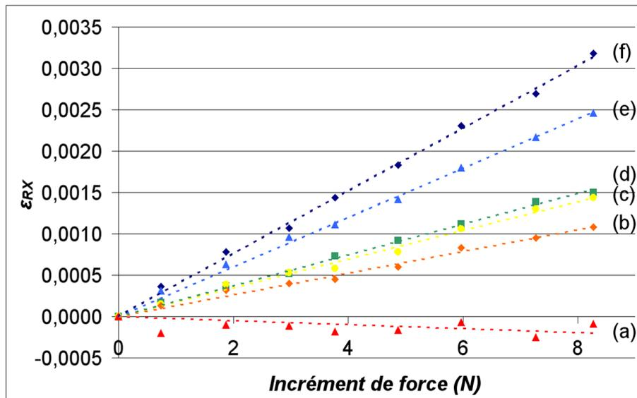
FIG. III.21 – Évolution de la déformation élastique  $\epsilon$  mesurée par diffraction des rayons X, concernant l'échantillon W/Cu 1,5/0,5, en fonction de l'incrément de force appliquée au composite film/substrat dans chacune des directions de pôle  $\psi$  investiguée : (a) 26,6°, (b) 43,1°, (c) 47,9°, (d) 50°, (e) 63,4° et (f) 68,6°.
