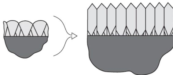
FIG. I.6 – Évolution de la morphologie des grains lors de la croissance, menant à un gradient de forme de grain et/ou de texture en profondeur [110].
