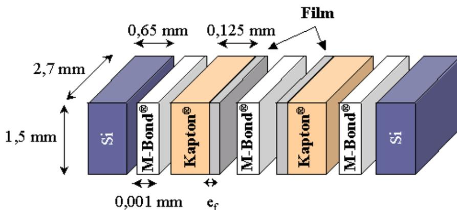
FIG. II.8 – Schéma descriptif des échantillons de microscopie électronique en transmission avec substrat de Kapton®.
