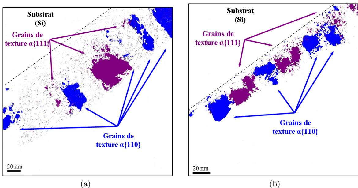
FIG. III.12 – Superposition des champs sombres sur les taches de diffraction  $\alpha\text{-W}\{110\}$  et  $\alpha\text{-W}\{222\}$  pour chaque zone de l'échantillon W/Cu 12/0,5 sur substrat de silicium.
