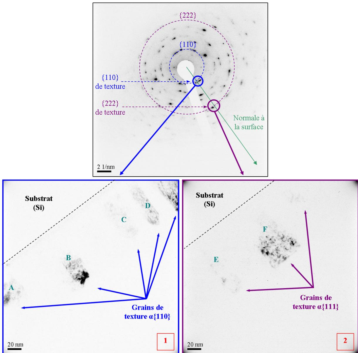
FIG. III.11 – Cliché de diffraction du film W/Cu 12/0,5 sur substrat de silicium et champs sombres associés aux taches de diffraction (1)  $\alpha\text{-W}\{110\}$  et (2)  $\alpha\text{-W}\{222\}$  de texture (négatifs des images originales)
