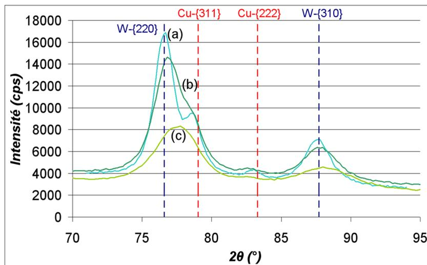
FIG. IV.13 – Diffractogrammes  $\theta$ - $2\theta$  ( $\psi=58,5^\circ, \phi=0^\circ$ ) des trois composites lamellaires (a) W/Cu 6/18 M, (b) W/Cu 3/9 M et (c) W/Cu 1,5/4,5 M. Les lignes pointillées bleues et rouges indiquent respectivement la position des pics de diffraction du cuivre et du tungstène massifs.
