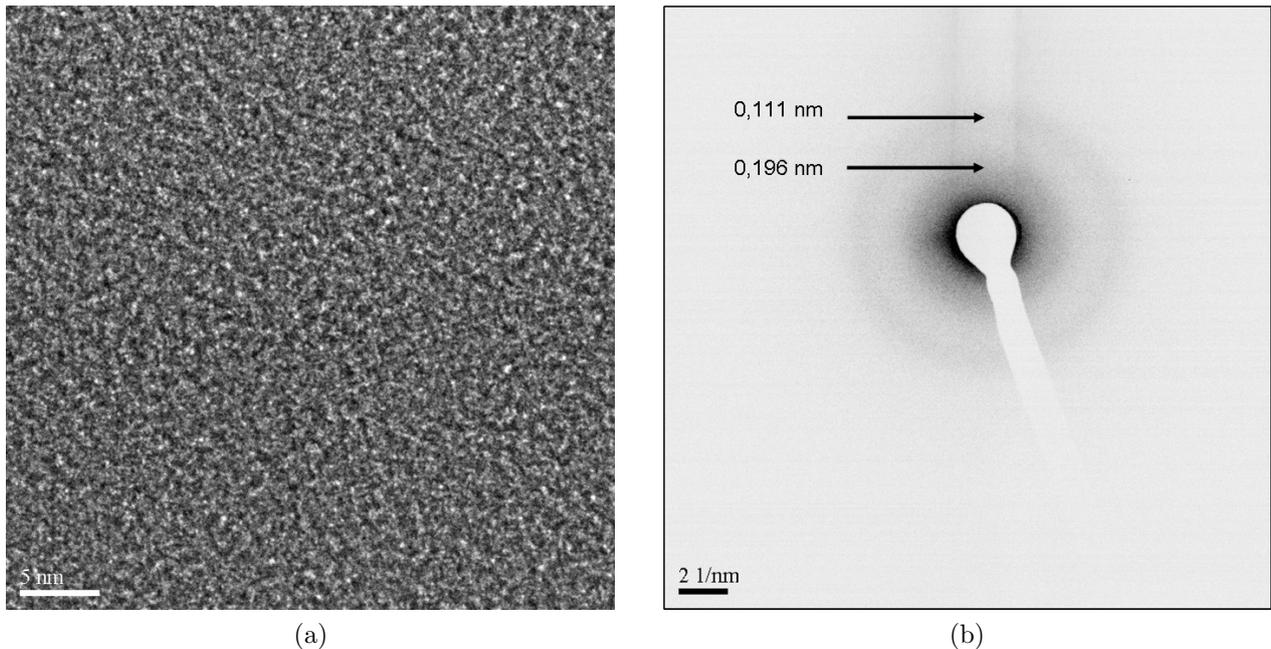
FIG. IV.27 – (a) Image haute-résolution en champ clair et (b) cliché de diffraction électronique réalisés sur substrat de Kapton<sup>®</sup> au cours de l'investigation effectuée sur l'échantillon W/Cu 6/18 I.
