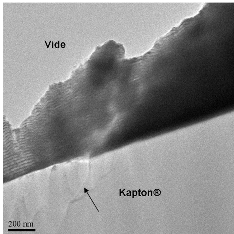
FIG. IV.33 – Image en champ clair d'une fissure au sein de l'échantillon W/Cu 6/18 M après traction. Son prolongement dans le Kapton<sup>®</sup> est indiqué par la flèche noire.
