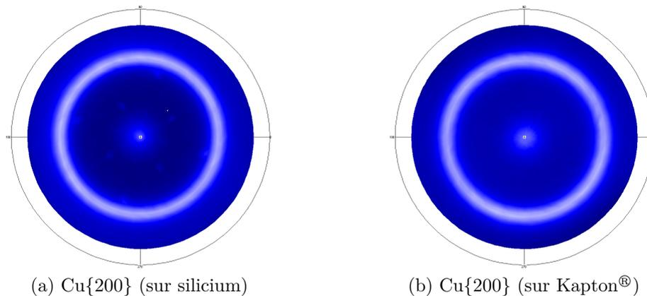
FIG. IV.8 – Figures de pôle réalisées sur W/Cu 6/18 M sur substrat (a) de silicium et (b) de Kapton<sup>®</sup>.
