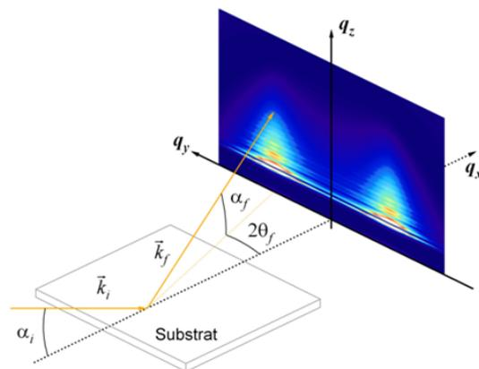
FIG. A.1 – Schéma de principe du GISAXS :  $\alpha_i$  est l'angle d'incidence du faisceau de rayons X,  $\alpha_f$  l'angle d'émergence de diffusion,  $2\theta_f$  l'angle de diffusion dans le plan de la couche,  $k_i$  et  $k_f$  les vecteurs d'onde incident et émergent,  $q_i$  la norme du vecteur de diffusion dans le repère orthonormé ( $i = x, y, z$ ).
