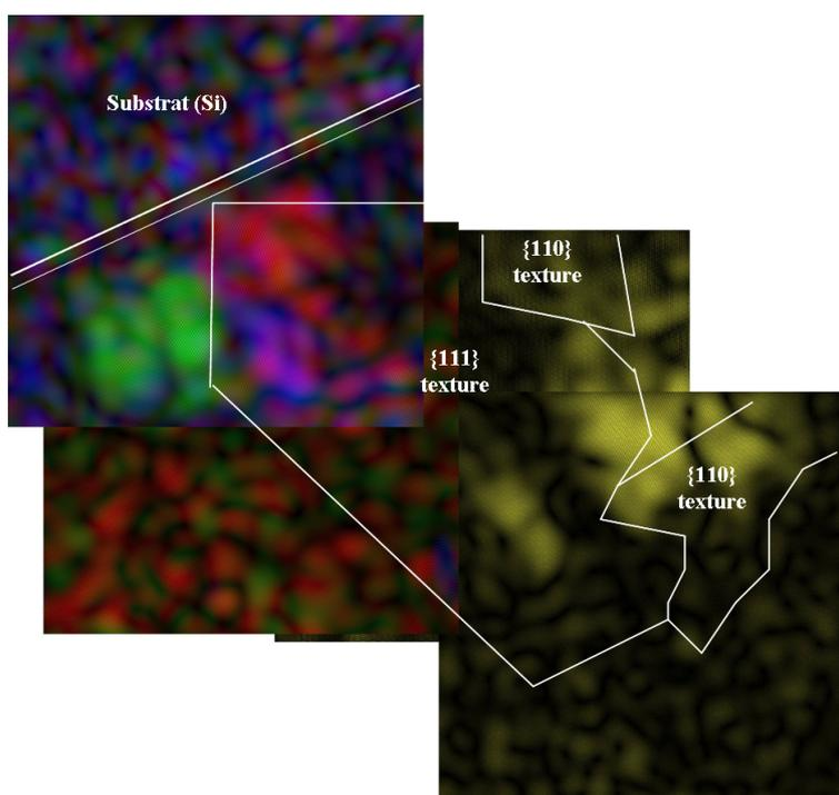
FIG. B.9 – Simulation de champs sombres à partir des taches  $\beta$ -W{200} des transformées de Fourier réduite (voir Fig. B.8) des images haute-résolutions de la figure B.7 réalisées sur l'échantillon W/W 16/16 sur substrat de silicium.
