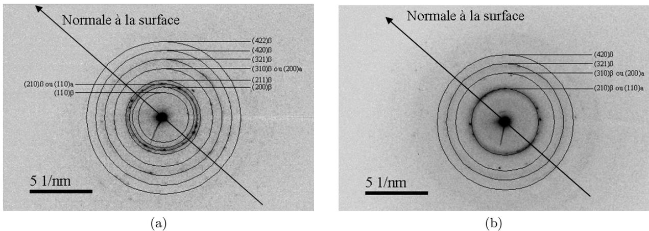
FIG. B.10 – Clichés de diffraction réalisés sur l'échantillon électronique W/W 1/1 sur substrat de silicium.
