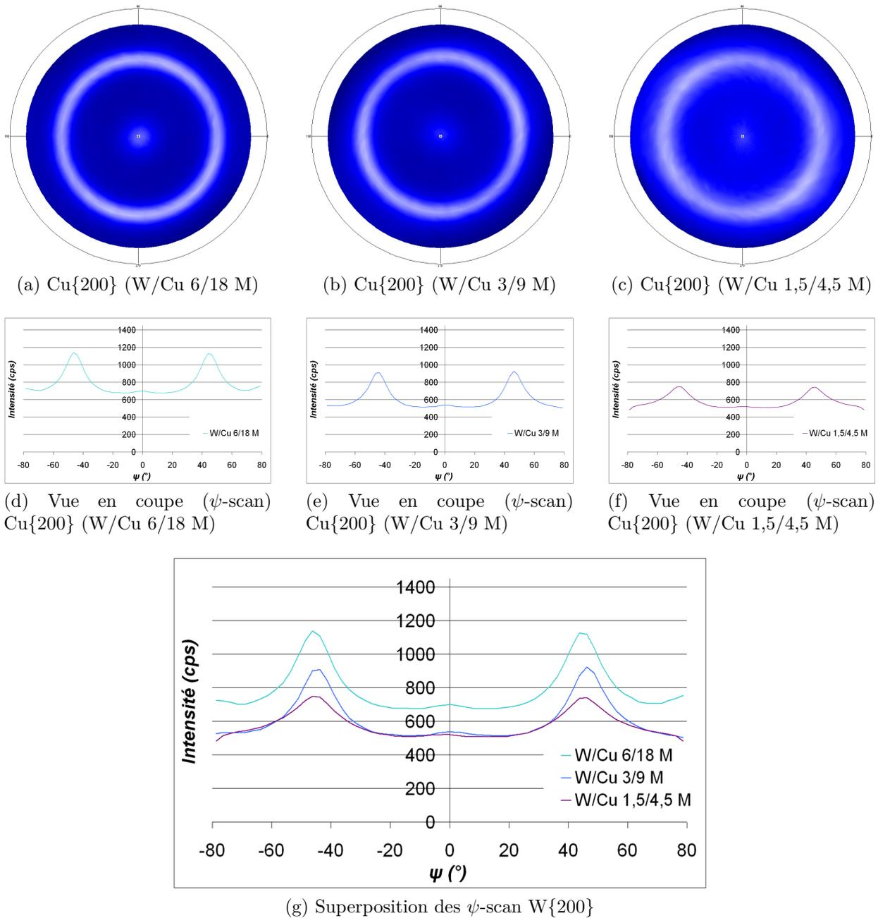
FIG. IV.15 – Figures de pôle réalisées sur les composites W/Cu lamellaires déposés sur substrat de Kapton<sup>®</sup> sur la tache de diffraction Cu{200} avec les profils associés.
