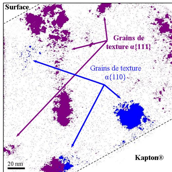
FIG. III.17 – Superposition des champs sombres sur les taches de diffraction  $\alpha$ -W{110} et  $\alpha$ -W{222} de l'échantillon W/W 2/2 sur substrat de Kapton®.
