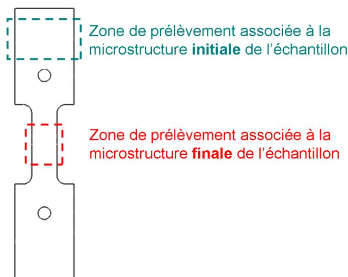
FIG. IV.26 – Zones de prélèvement des spécimens utilisés lors de la préparation des lamelles de microscopie électronique en transmission témoignant de la microstructure de l'échantillon avant et après traction au delà de la limite d'élasticité.
