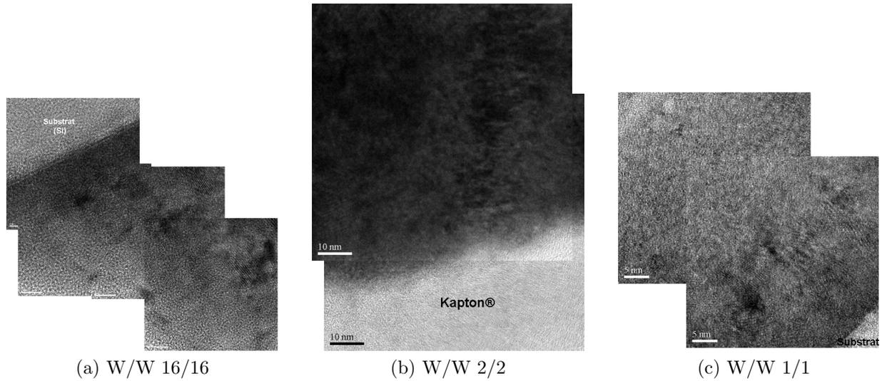
FIG. B.2 – Images haute-résolution réalisées sur les échantillons (a) W/W 16/16 (sur substrat de silicium), (b) W/W 2/2 (sur substrat de Kapton<sup>®</sup>) et (c) W/W 1/1 (sur substrat de silicium).
