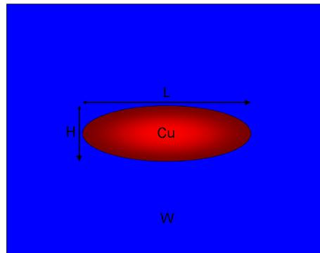
FIG. III.23 – Modèle de Mori-Tanaka appliqué au composite W/Cu.
