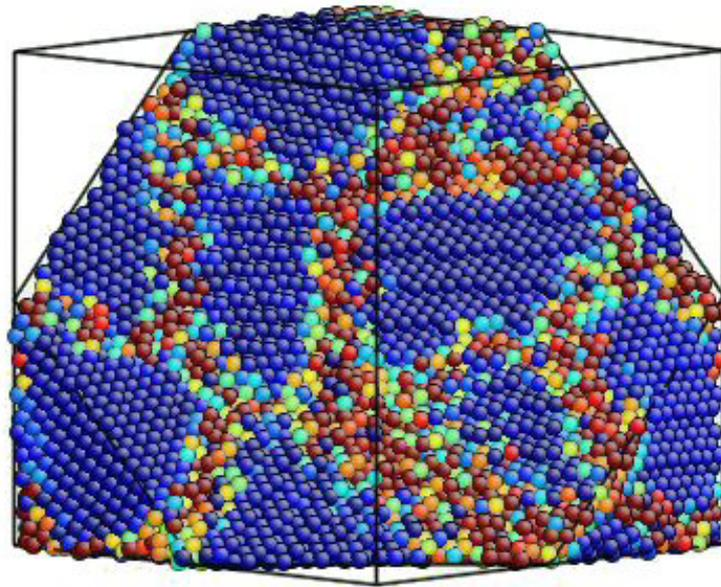
FIG. I.4 – Polycristal réalisé par F. Allard et P. Valat par simulation en dynamique moléculaire présentant une taille de cristallite  $D$  (bleus) et des joints de grains de largeur  $d$  (multicolores).
