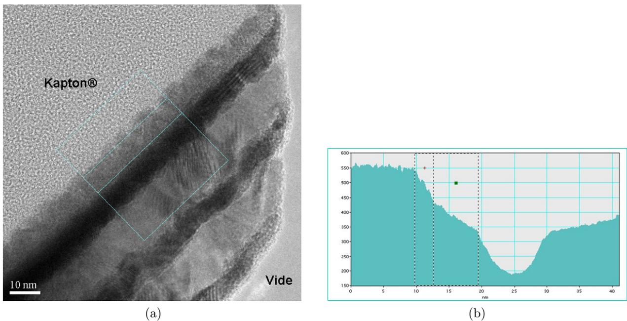
FIG. IV.28 – (a) Image haute-résolution et (b) profil d'intensité de l'interface film-substrat de l'échantillon W/Cu 6/18 M déposé sur Kapton<sup>®</sup>.
