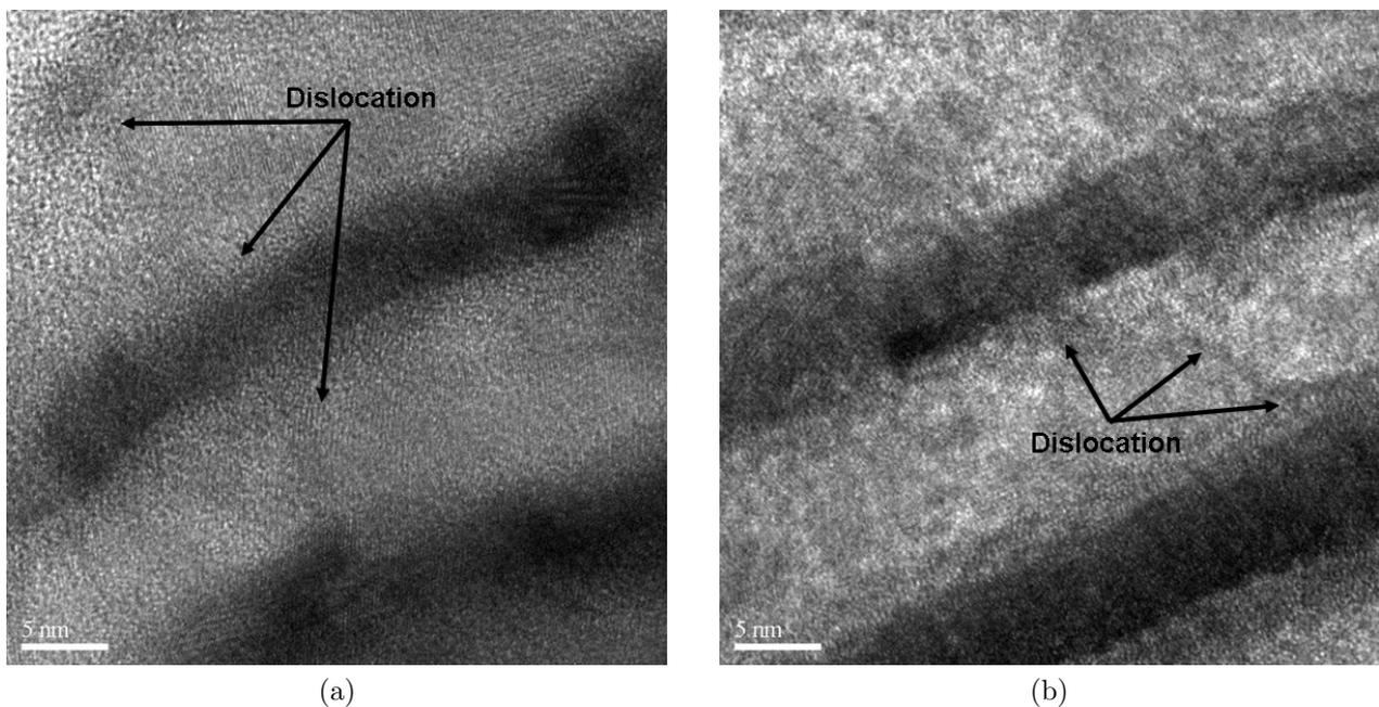
FIG. IV.32 – Images haute-résolution de deux régions de l'échantillon W/Cu 6/18 M déposé sur Kapton<sup>®</sup> après traction au delà du domaine élastique. Les flèches indiquent la localisation de lignes de contraste.
