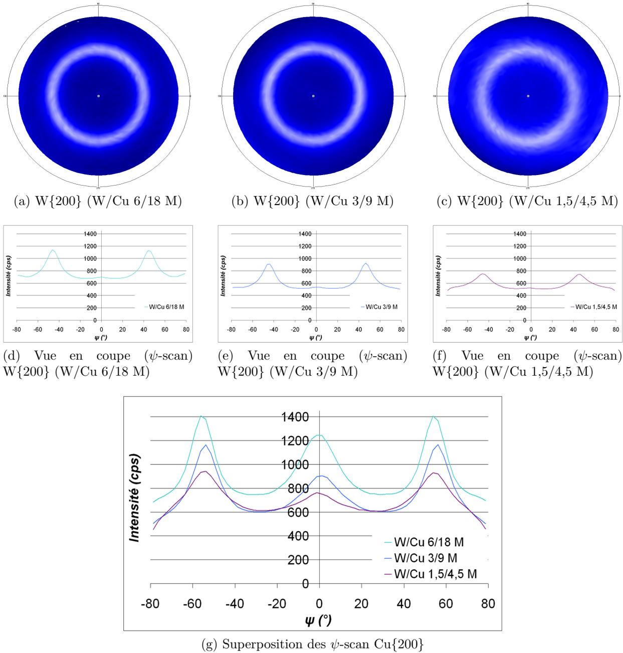
FIG. IV.14 – Figures de pôle réalisées sur les composites W/Cu lamellaires déposés sur substrat de Kapton<sup>®</sup> sur la tache de diffraction  $\alpha$ -W{200} avec les profils associés.
