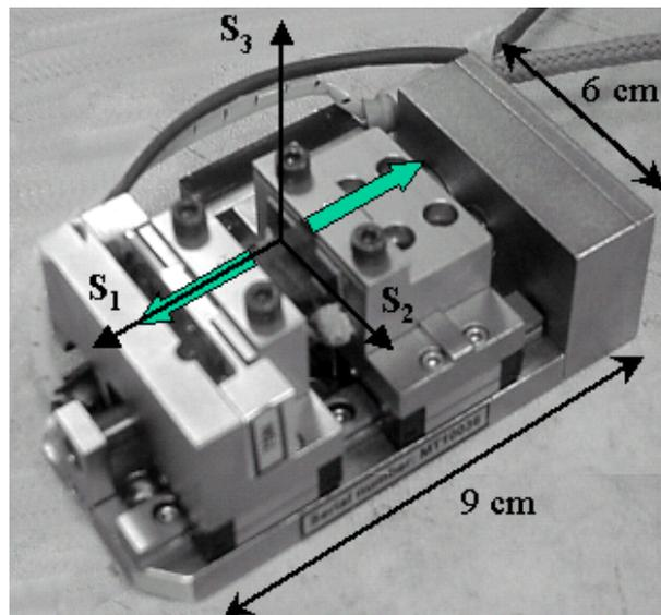
FIG. II.10 – Machine de traction Deben<sup>TM</sup> 200  $N$ .
