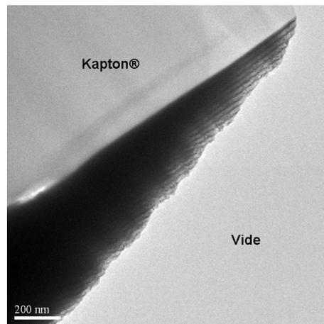
FIG. IV.10 – Image en champ clair de la zone d'investigation sur la lame mince W/Cu 6/18 M sur Kapton<sup>®</sup>.
