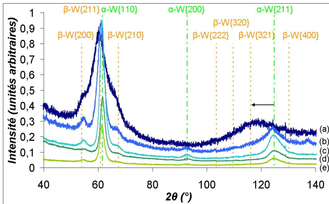
FIG. B.4 – Diffractogrammes  $\omega$ - $2\theta$  des échantillons (a) W/W 1/1, (b) W/W 2/2, (c) W/W 3/3, (d) W/W 8/8 et (e) W/W 16/16 sur substrat de silicium. Les lignes pointillées verticales indiquent la position attendue des pics de diffraction des phases  $\alpha$  (en vert) et  $\beta$  (en orange) du tungstène.
