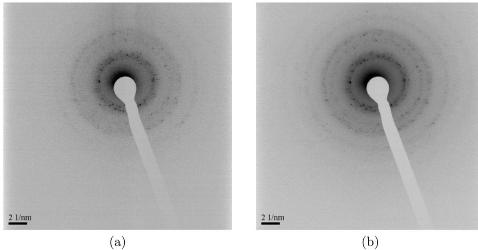
FIG. III.18 – Clichés de diffraction réalisés sur deux zones du substrat de Kapton<sup>®</sup>.
