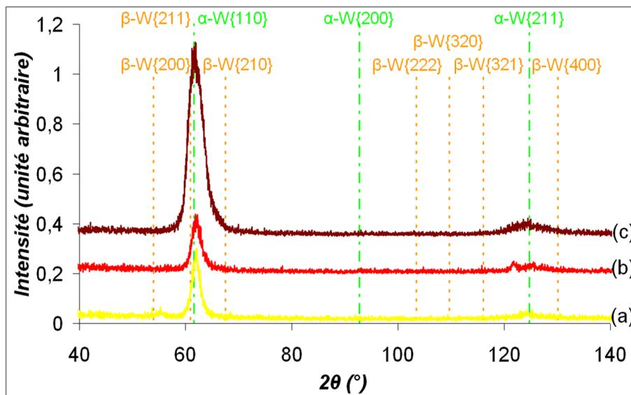
FIG. III.8 – Diagrammes de diffraction obtenus sur le diffractomètre INEL pour une incidence fixe  $\omega$  de  $30^\circ$  : (a) W/W 3/3, (b) W/Cu 3/0,5 et (c) W/Cu 3/1. Les lignes verticales donnent les positions attendues des pics de diffraction pour les deux phases du tungstène selon les fiches standards ICDD - PDF N°4-806 pour  $\alpha$ -W et N°47-1319 pour  $\beta$ -W. (ICDD - PDF est l'abréviation de International Center for Diffraction Data - Powder Diffraction File).
