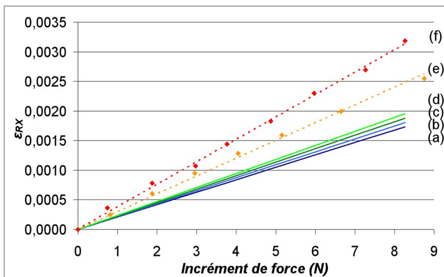
FIG. III.28 – Effet de l'adoucissement de (a) 0%, (b) 30%, (c) 60%, (d) 90% des coefficients d'élasticité sur les déformations attendue dans le modèle de couches continues de cuivre en ( $\phi = 0^\circ$ ,  $\phi = 68,6^\circ$ ) en comparaison aux mesures réalisées sur les échantillons (e) W/Cu 3/0,5 et (f) W/Cu 1,5/0,5.
