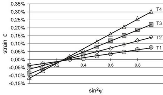
(a) Déformation d'un film polycristallin de W en fonction de  $\sin^2\psi$  pour la famille de plans 211. La charge appliquée est croissante de T1 à T4 [72].
