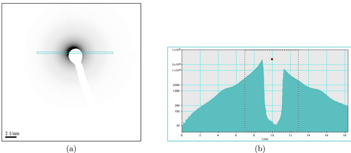
FIG. IV.12 – (a) Cliché de diffraction électronique réalisé sur Kapton® (négatif) et (b) profil d'intensité radial associé.
