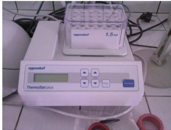
**Fig. A.8 :** Thermostat utilisé pour chauffer la trypsine
