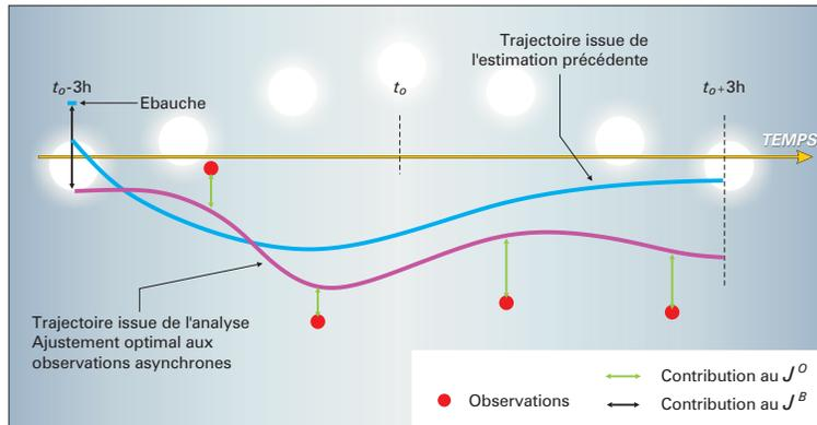
**FIG. 2.3** – Principe du 4D-Var. Source : Malardel [2005], Météo-France.
