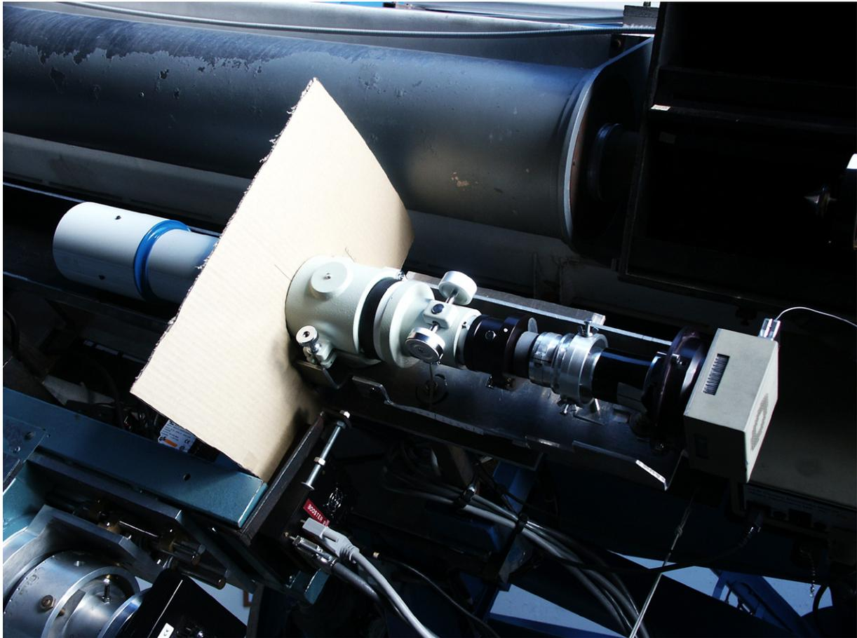
**Figure III.3.1.4** – Au Pic du Midi à partir de 2006 une nouvelle caméra CCD White refroidie à 16 bits a été mise en place pour obtenir des images en noir et blanc avec la lunette TAKAHASHI et le filtre Coronado 60 mm.
