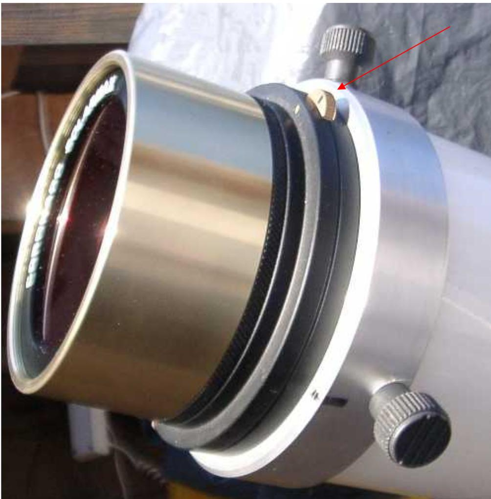
**Figure III.3.2.1** – Filtre Coronado (Fabry-Perot) de 90 mm de diamètre monté devant une lunette, avec la molette de réglage de longueur d'onde indiquée (flèche rouge).
