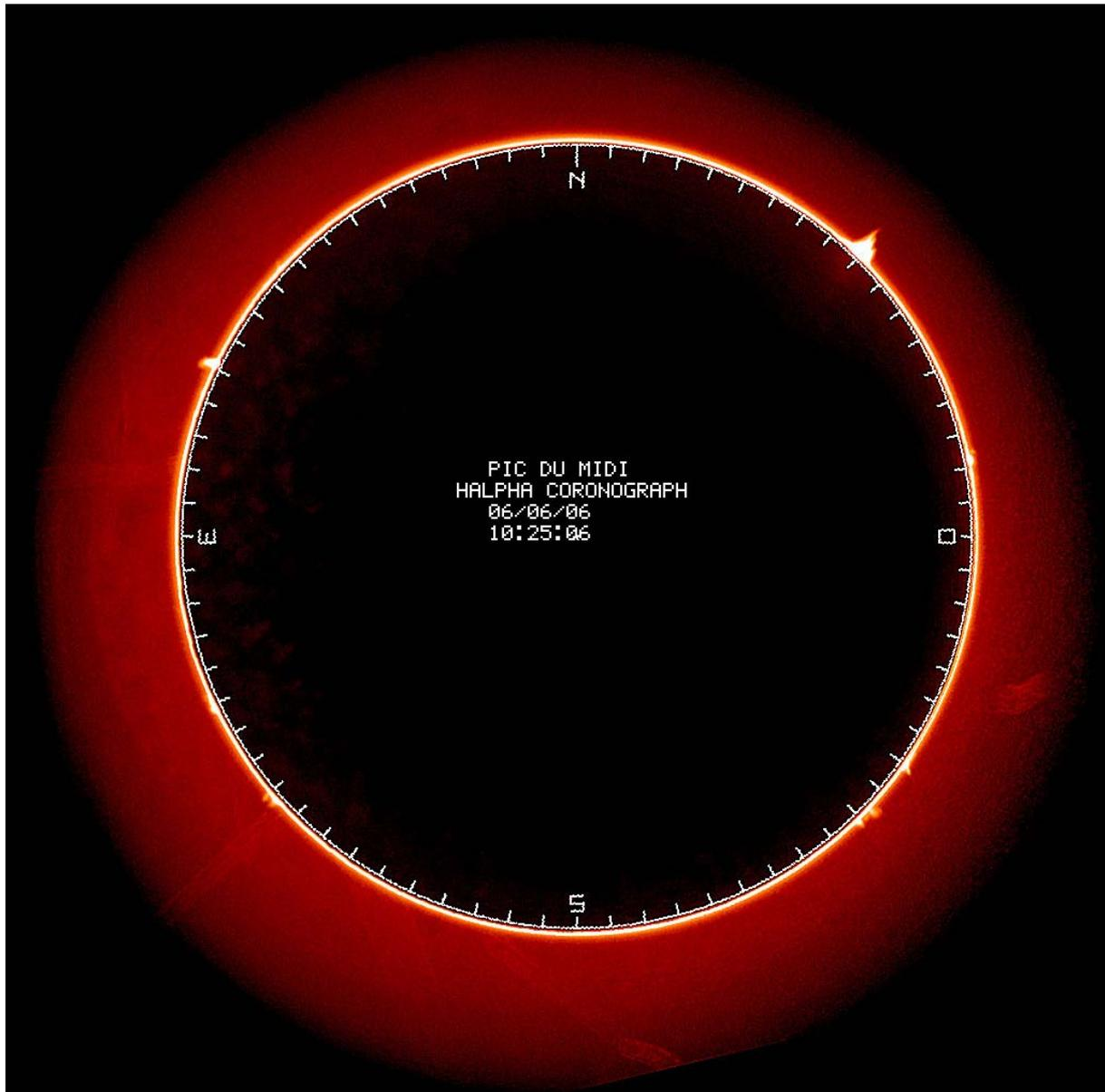
**Figure II.4.2.5** – La frange de diffraction sur l'image sélectionnée obtenue avec l'instrument HACO au Pic du Midi le 06 juin 2006 à 10h25m06s T.U., dont l'analyse semble indiquer une ovalisation *NS* qui ne peut pas s'expliquer par la réfraction différentielle car le Soleil est haut dans le ciel ( $h > 60^\circ$ ) et la R.D. produit l'effet inverse.
