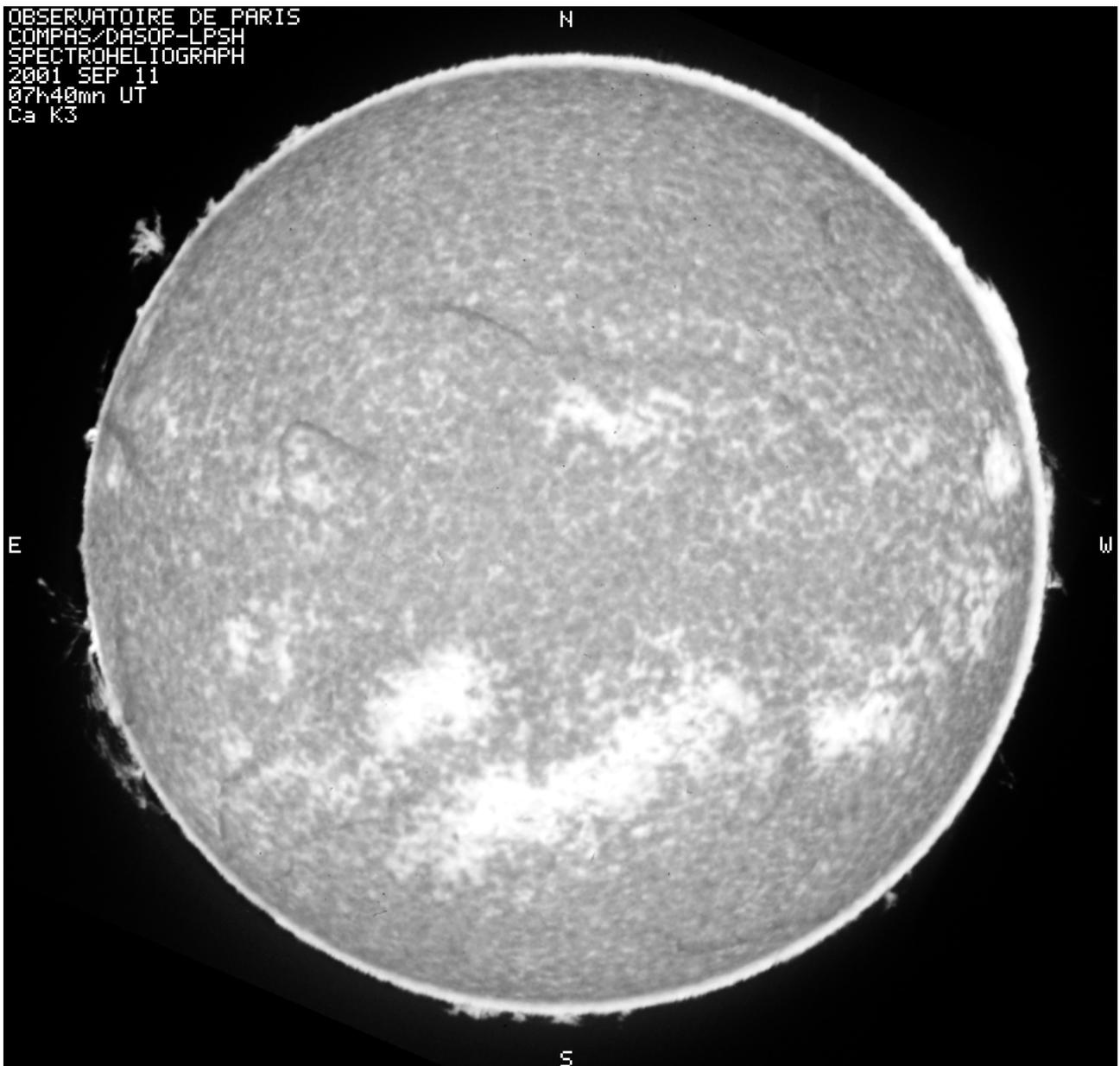
**Figure II.4.1.1** – Sur ce spectrohéliogramme en *Ca II K3* de Meudon fait le 11 septembre 2001 à 07h40m TU le décentrage du disque occulteur est évident et on peut aussi remarquer des défauts de netteté sur le bord du Soleil qui est quelque peu confondu avec le bord flou du masque, ce qui rend très difficile ou impossible d'effectuer une mesure de l'épaisseur de la chromosphère.
