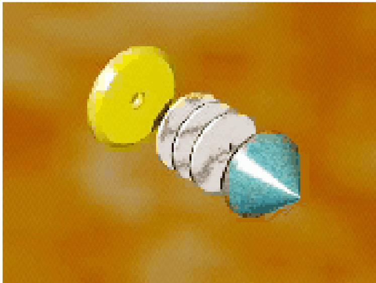
**Figure II.4.2.2** – Le disque occulteur est protégé par un cône (en bleu sur le dessin) de la chaleur provoquée par la convergence des rayons solaires à cet endroit. Disque et cône sont séparés par trois rondelles de mica. L'ensemble, vissé sur la lentille de champ, doit occulter ainsi la lumière intense émise par la surface du Soleil et ne laisser apparaître que celle de la couronne (d'après les O.A.).
