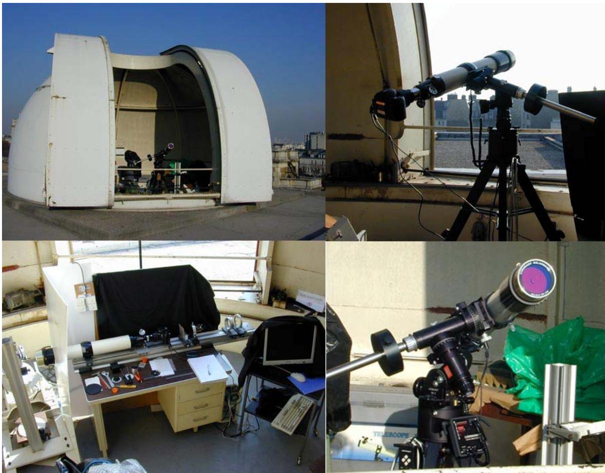
**Figure III.3.1.1** – Mosaïque montrant le dispositif installé à la coupole de l'I.A.P. : monture équatoriale *G-11 "Gemini"* de *Losmandy (USA)*, avec système de poursuite motorisé en  $\alpha$  et en  $\delta$  et corrections différentielles manuelles avec filtre Coronado 90mm. La configuration "horizontale" utilisant le sidérostas polaire est montrée en bas à gauche.
