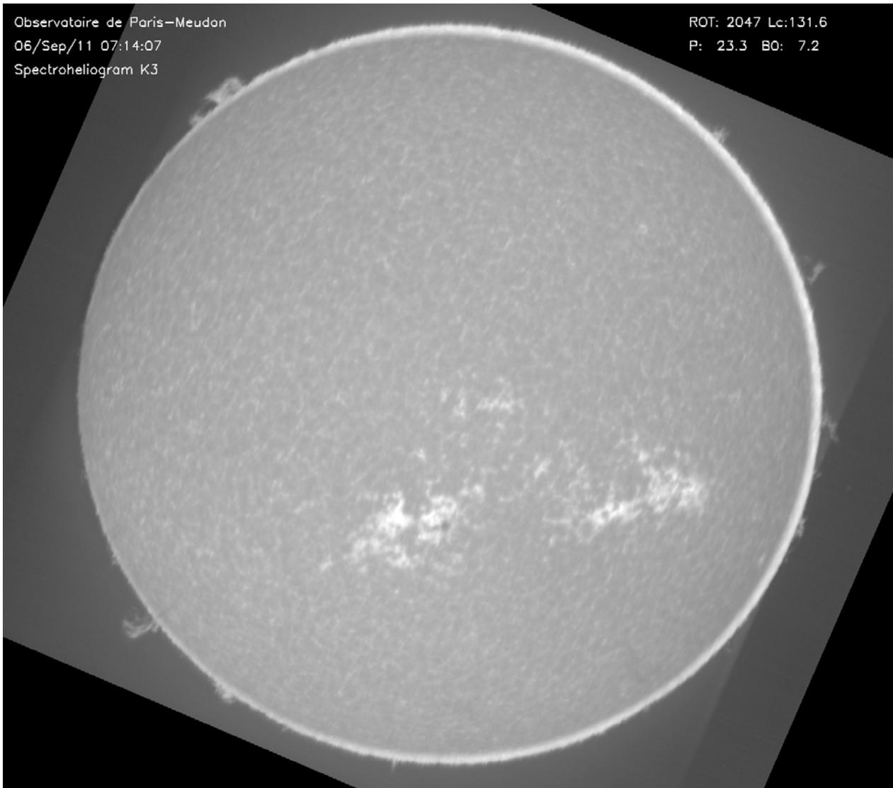
**Figure II.4.1.2** – Cinq ans après l'image de la figure II.4.1.1, spectrohéliogramme en *Ca II K3* obtenu également à Meudon le 11 septembre 2006 à 07h14m07s TU. On peut toujours voir nettement le décentrage du disque occulteur et l'absence de netteté du bord solaire.
