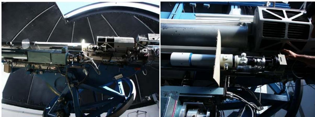
**Figure II.3.1.2** – Le dispositif du Pic du Midi (2004-2006): lunette TAKAHASHI de 80 mm, doubleur de focale, filtre Coronado de 60 mm et la Canon 300D équipée d'un chip CMOS de 6.2 Mpx est installé sur la grande table équatorial des coronographes.
