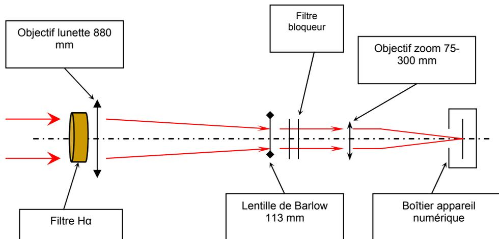
**Figure II.3.2.3** – Dispositif utilisé à l'I.A.P. pour mesurer les variations de la position de la bande passante du F.-P. Coronado en fonction de différentes inclinaisons et pour effectuer des prises de vue du disque entier derrière le système avec sidérostas polaire.
