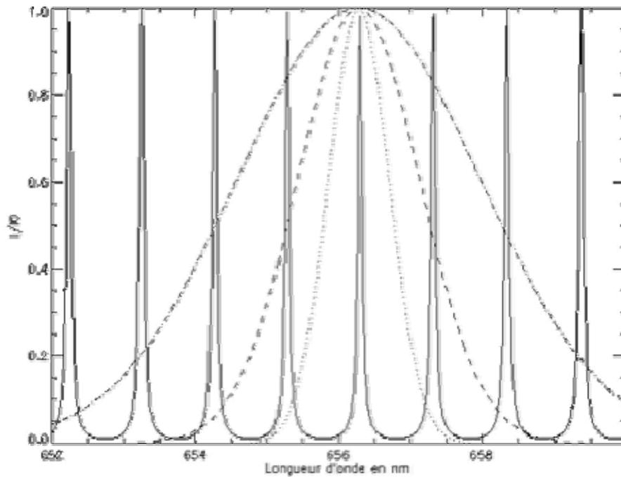
**Figure III.3.2.2** - Spectre théorique cannelé pour  $r=0.9$ ,  $e=211 \mu$  en incidence normale ( $i=0$ ); les trois courbes en cloche représentent la fonction de transmission gaussienne d'un filtre interférentiel de 1, 2 ou 4 nm de largeur à mi hauteur centré sur  $H\alpha$  (d'après J.M. Malherbe et Nicole Mein, 2006).
