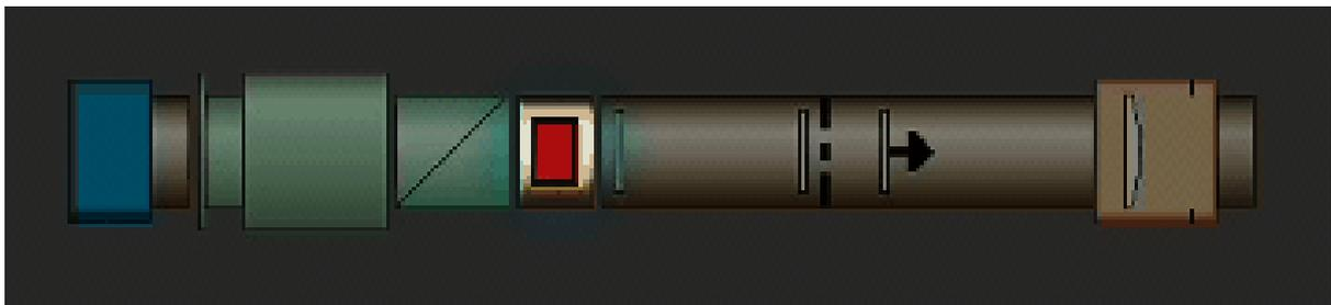
**Figure II.4.2.1** - L'objectif du coronographe (à droite) est une lentille simple peu diffusante dont l'image primaire du Soleil est formée sur un disque occulteur, très légèrement plus grand que la taille de l'image du Soleil. La lumière émise les protubérances est isolée à l'aide d'un filtre interférentiel (0.35 nm ou 3.5Å), qui ne laisse passer que la raie H $\alpha$  de l'hydrogène (à 656.3 nm de longueur d'onde, émise dans le rouge).
