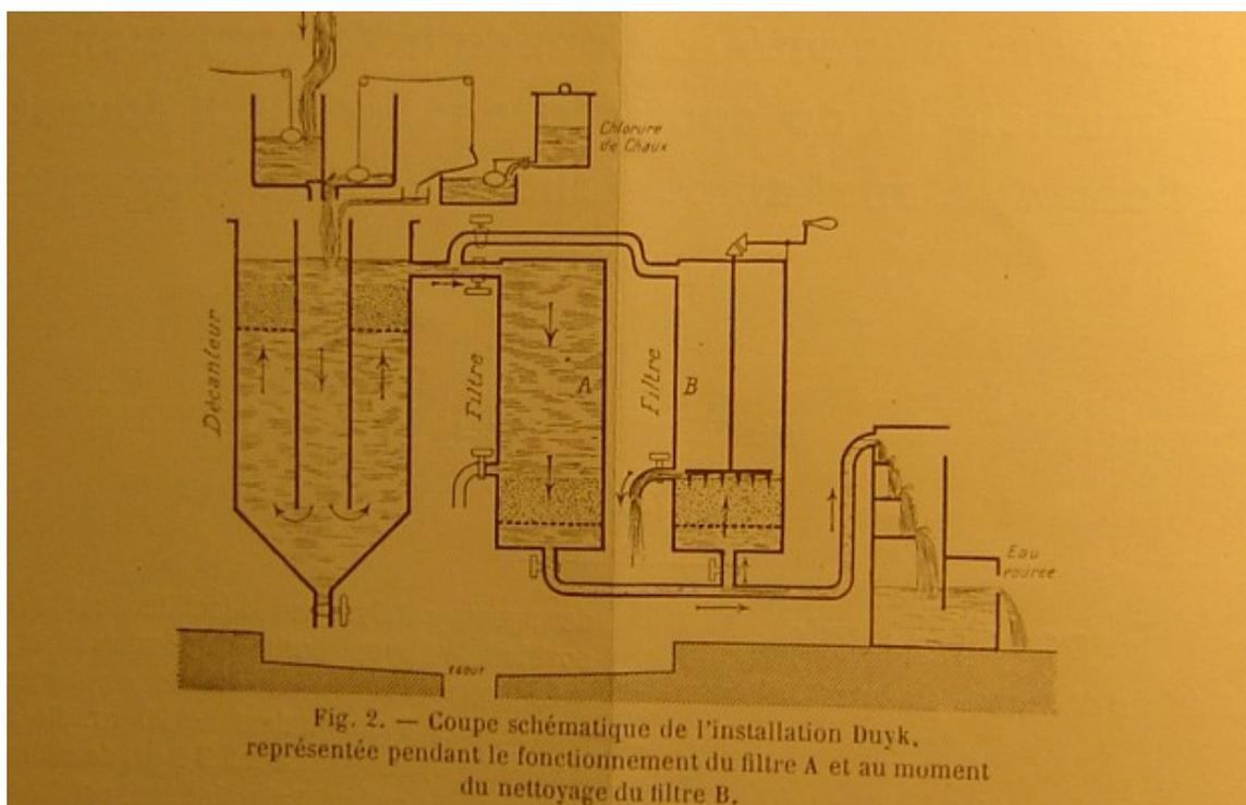
Fig. 2. — Coupe schématique de l'installation Duyk, représentée pendant le fonctionnement du filtre A et au moment du nettoyage du filtre B.
