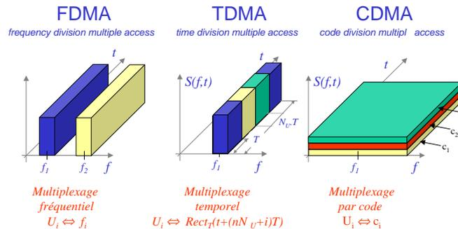
FIGURE 3.1 – Techniques d'accès multiple : FDMA, TDMA et CDMA.
