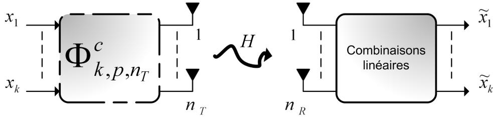
FIGURE 1.5 – Synopsis d'un système de codage spatio-temporel par bloc  $(n_T, n_R)$ , prenant en entrée une séquence de  $k$  symboles encodée sur  $p$  périodes par la matrice  $\phi_{k,p,n_T}^c$  dont les éléments de chaque colonne sont transmis en parallèle et simultanément via les  $n_T$  antennes.
