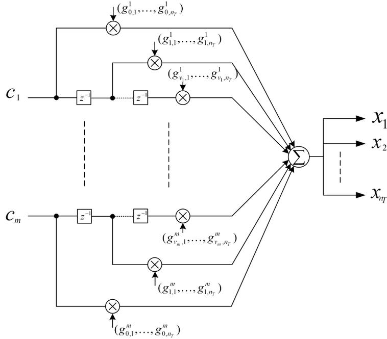
FIGURE C.1 – Architecture de l'encodeur CSTT pour  $n_T$  antennes émettrices.
