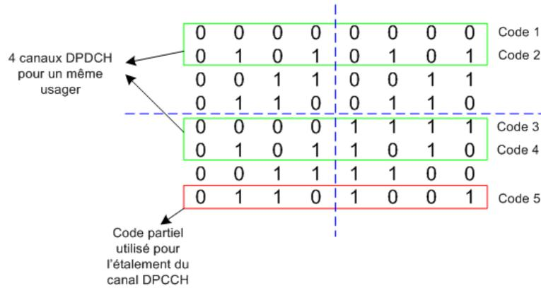
FIGURE 3.42 – Exemple de sélection de 5 codes OVSF (matrice d'Hadamard) : 1 code pour le canal DPCCH et 4 codes pour les 4 canaux DPDCH ( $FE = 8$ ), alloués à un usager.
