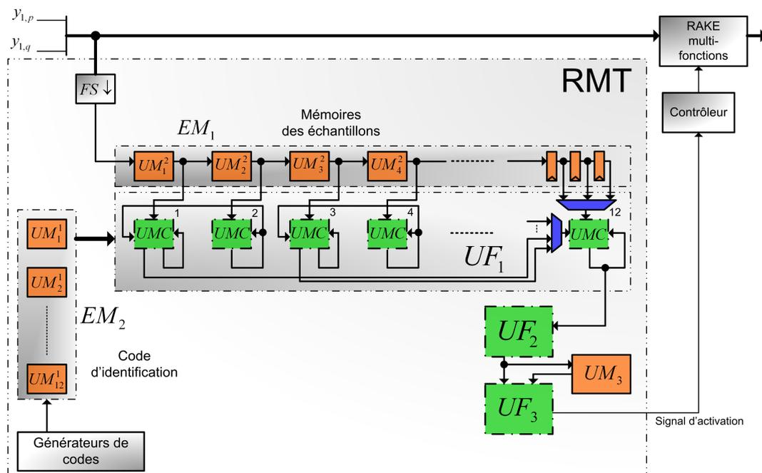
FIGURE 3.30 – Architecture initiale du module de recherche des multiples trajets pour un lien point à point.
