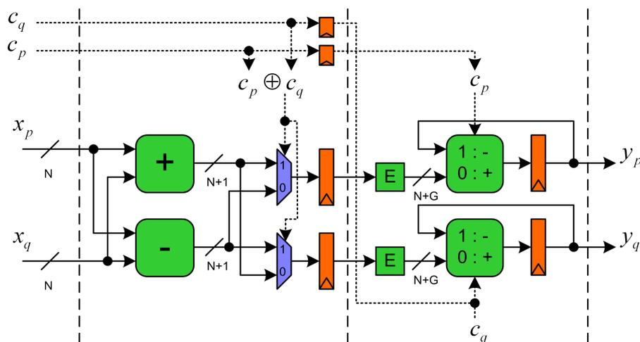
FIGURE 3.29 – Structure de l'UMC, constituée d'additionneurs et de soustracteurs avec  $G$  bits de garde ( $G = \log_2(FE)$ ,  $FE$  étant le facteur d'étalement).
