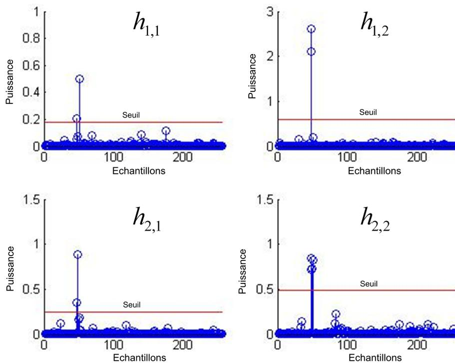
FIGURE 3.50 – Profil de puissance en délai pour chacun des quatre sous-canaux composant le canal DIDO sans fil sélectif en fréquences, caractérisé par un RSB fixé à 10 dB,  $f_d = 7,36$  Hz (3 km/h) et quatre trajets.
