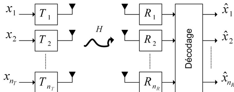
FIGURE 1.7 – Modèle général du système multi-antennes.
