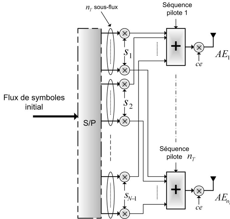
FIGURE 1.10 – Architecture de l'émetteur composé de  $n_T$  antennes pour la technologie HSDPA.
