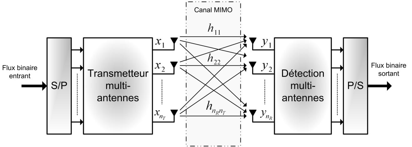
FIGURE 1.1 – Schéma général d'un système de transmission sans fil multi-antennes.
