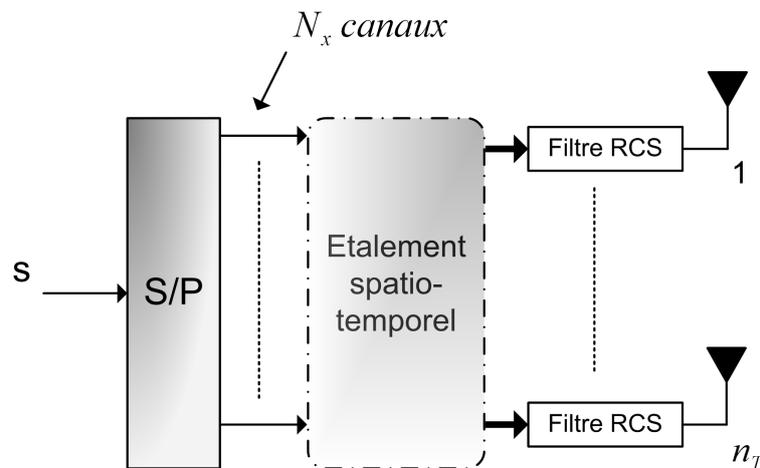
FIGURE 3.44 – Diagramme général de l'émetteur MIMO-WCDMA.
