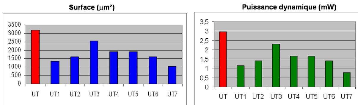
FIGURE 3.27 – Représentation du gain en surface ( $mm^2$ ) et en consommation dynamique (mW) des multiplieurs, pour la technologie 130 nm. En rouge sont indiquées les performances du multiplieur d'origine (8 par 10 bits). En abscisse, les indices de 1 à 7 identifient l'*UT* au sein duquel est intégré le multiplieur 8 par  $x$  bits, avec  $x = 4, 5, 8, 6, 6, 5, 3$ .
