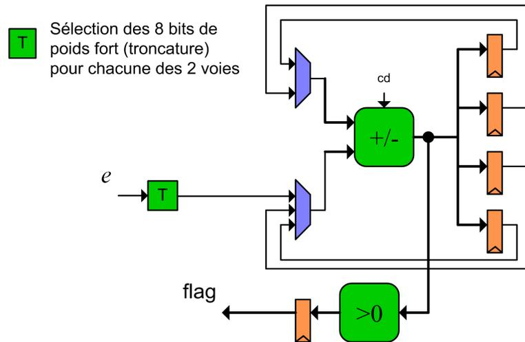
FIGURE 3.39 – Architecture interne de l'unité UF procédant à l'identification de la voie d'échantillons la plus pertinente (synchronisation fine).
