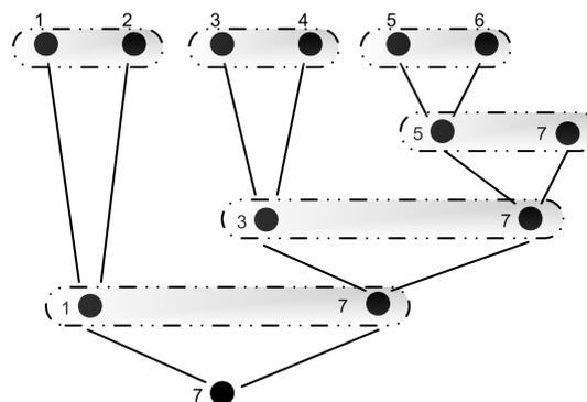
FIGURE 3.23 – Addition des produits partiels sous forme d'arbre, pour le filtrage de RCS.
