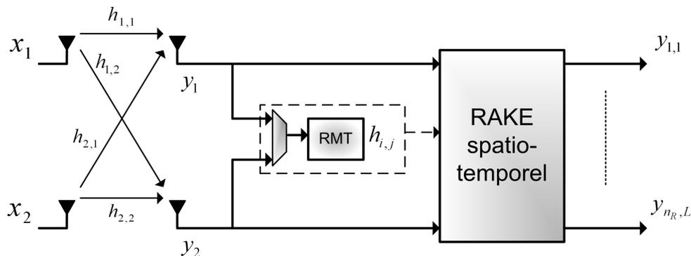
FIGURE 3.54 – Architecture du module RMT spatio-temporel (système  $2 \times 2$ ) intégrant une seule unité RMT chargée de sonder un seul sous-canal ( $h_{i,j}$ ), choisi en fonction du nombre de trajets détectés.
