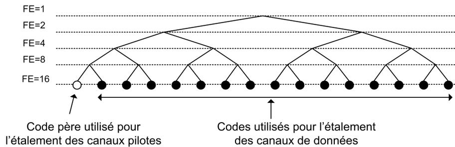
FIGURE 3.45 – Représentation sous forme d'arbre, de l'allocation des codes OVFSF, suivant le facteur d'étalement (FE), pour la technologie HSDPA.
