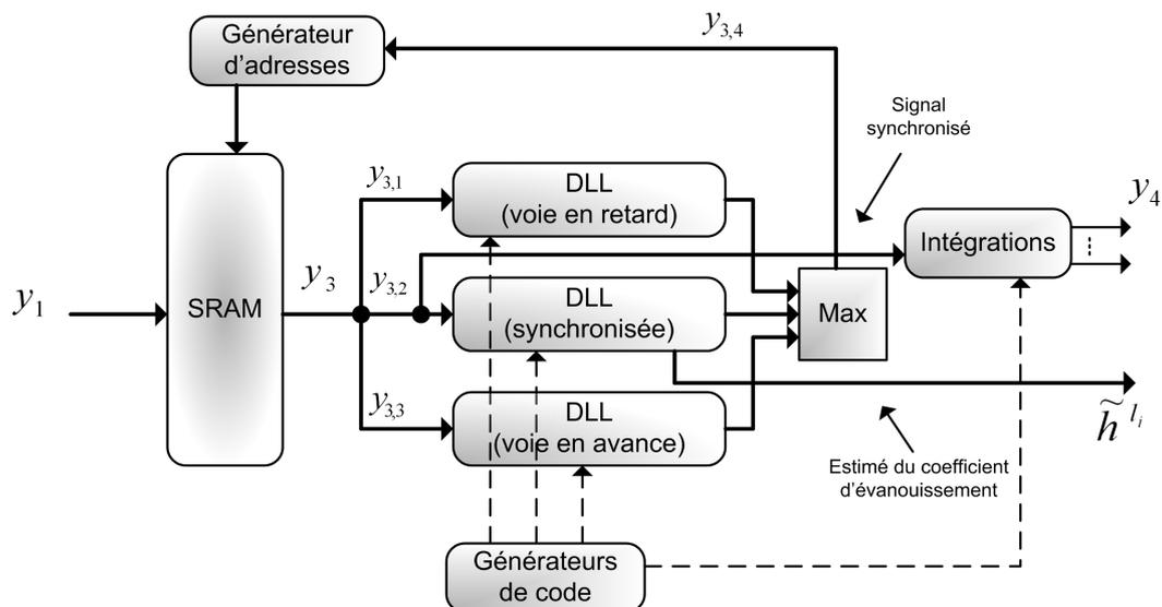
FIGURE 3.14 – Diagramme fonctionnel d'un *finger* intégrant trois boucles d'asservissement en temps (DLL), effectuant une synchronisation fine, le calcul de l'estimé du coefficient complexe du canal  $\tilde{h}^{l_i}$  pour le trajet  $l_i$  et la génération des statistiques des différents symboles, transmis par les multiples canaux.
