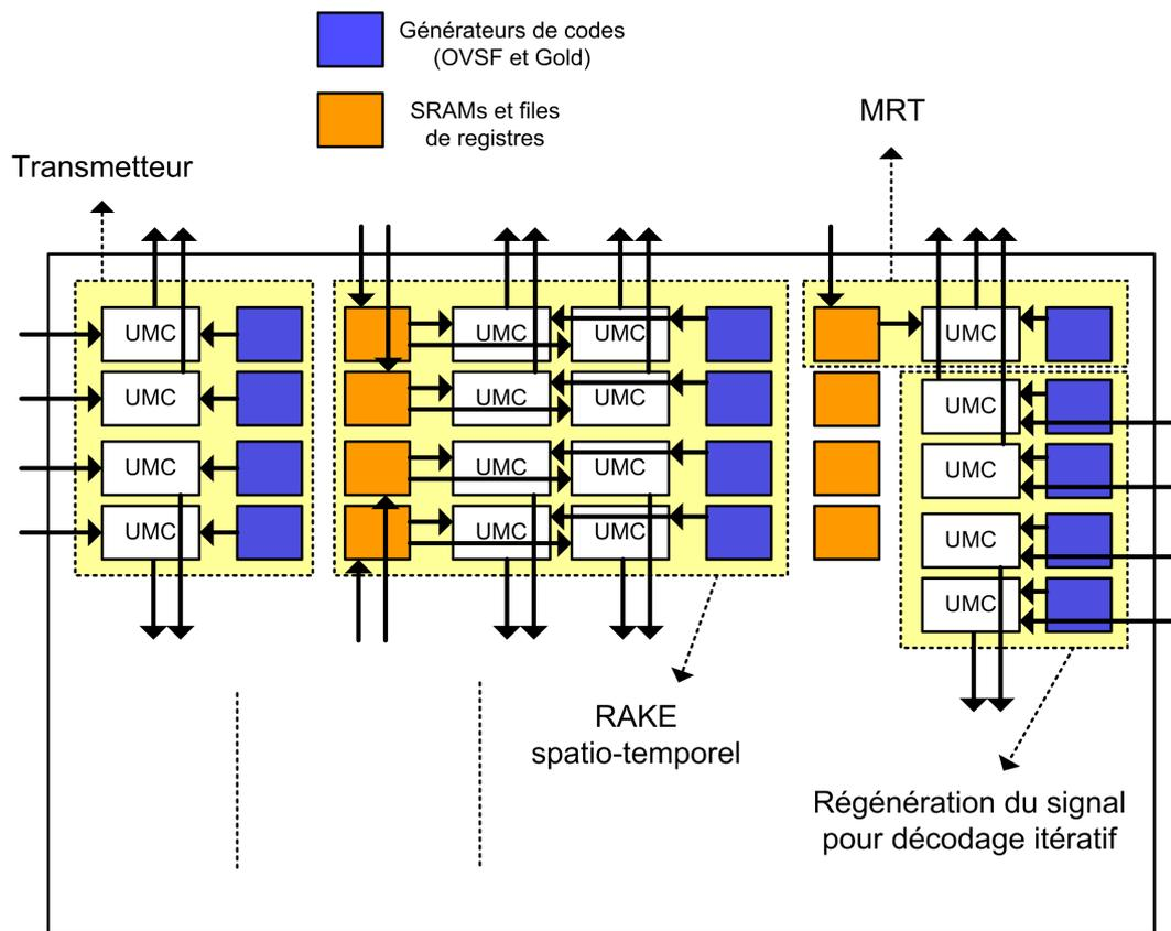
FIGURE 4.3 – Illustration de l'utilisation des ressources du réseau d'UMC programmable, configuré pour exécuter un système HSUPA avec  $n_T = n_R = 4$ .
