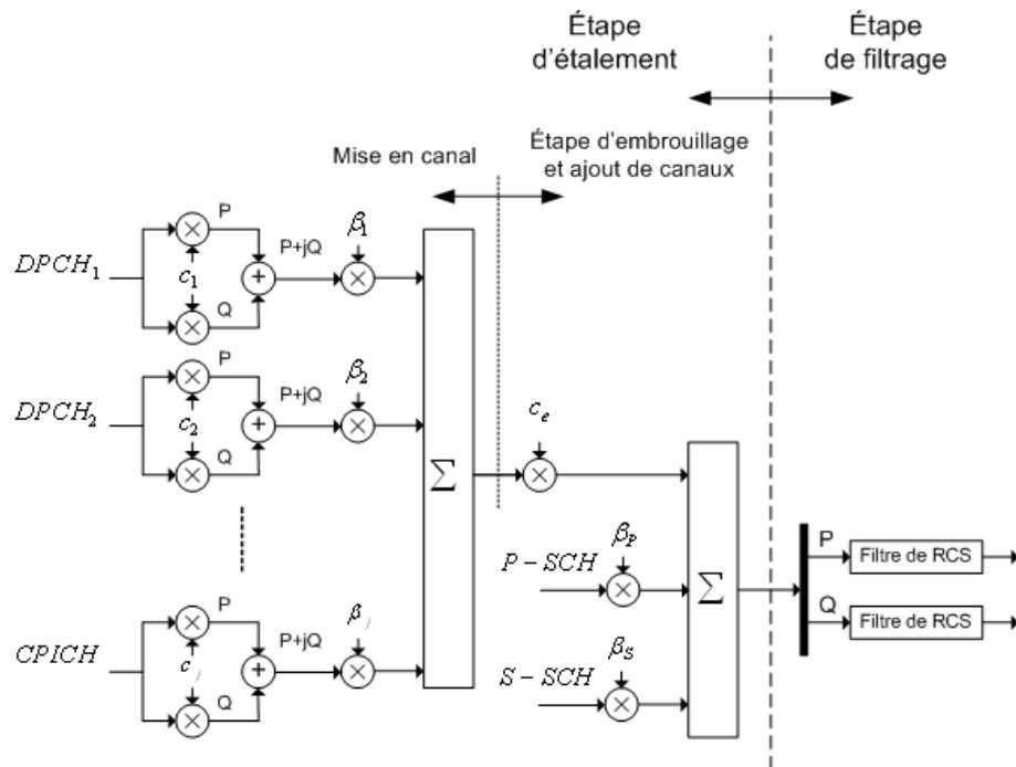
FIGURE 3.7 – Structure de l'émetteur (étape d'étalement suivie du module de filtrage de RCS) pour la *voie descendante*, spécifiée pour la couche physique de l'UTRA, en mode FDD [109].
