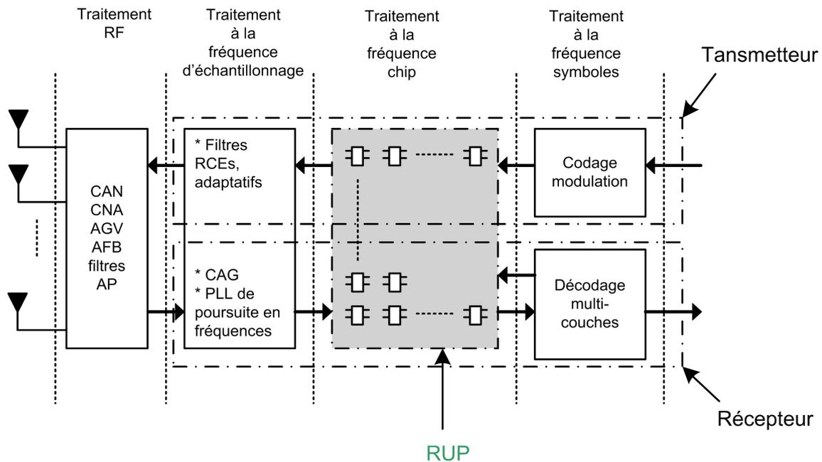
FIGURE 4.2 – Exemple d'intégration du réseau d'UMC programmable au sein d'un récepteur MIMO-WCDMA.
