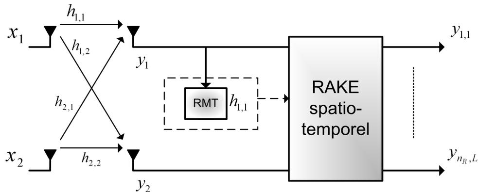
FIGURE 3.53 – Architecture du module RMT spatio-temporel (système  $2 \times 2$ ) intégrant une seule unité RMT chargée de sonder un seul sous-canal ( $h_{1,1}$ ), basée sur l’hypothèse raisonnable de retards identiques d’un sous-canal à un autre.
