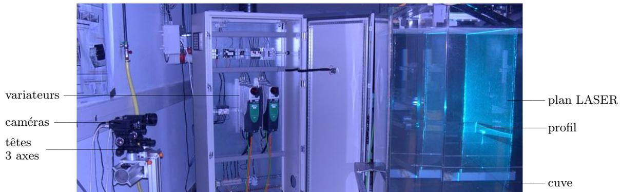
FIG. 3.9 – Vue d'ensemble du montage expérimental.
