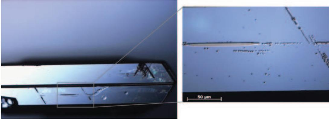
**Figure V.14** – Evaluation de la densité de dislocations à partir de l'imagerie au microscope optique à contraste interférentiel. Observation de la face  $(111)_{Si}$  d'un cristal de 3C=SiC après attaque KOH à 530°C pendant 2 minutes. La densité de dislocations sur la zone agrandie est de  $3 \times 10^5 \text{ cm}^{-2}$ . Croissance spontanée dans Si à 1650°C.
