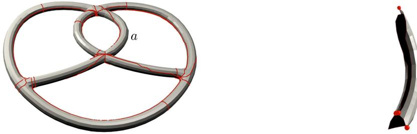
FIG. 5.10 – Gauche : quadrangulation après découpage topologique initial (algorithme 3.2) d'une surface de genre quatre. Droite : détail sur la tuile  $a$  à la géométrie médiocre.
