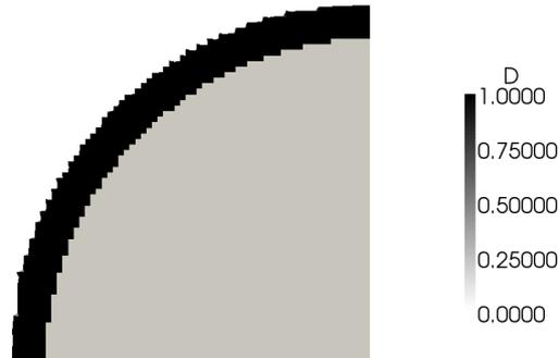
FIG. 6.29: Carte d'endommagement, modèle visco-plastique visco-endommageable -  $t = 0,5\text{ms}$
