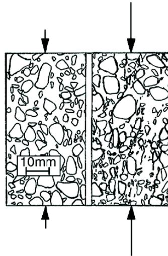
**FIG. 1.5:** Évolution de la micro-fissuration en compression - pétrographie Shah
