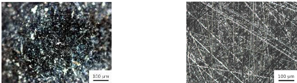
FIG. 2.4: Image en champ sombre au microscope photonique d'une bille (à gauche) et d'un plan (à droite) en acier après les étapes de polissage et de nettoyage. Il n'y a pas d'orientation préférentielle des rayures.
