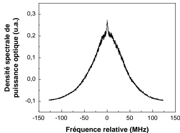
FIG. 4.22 – Spectre du laser injecté très faiblement par un maître spectralement plus fin.
