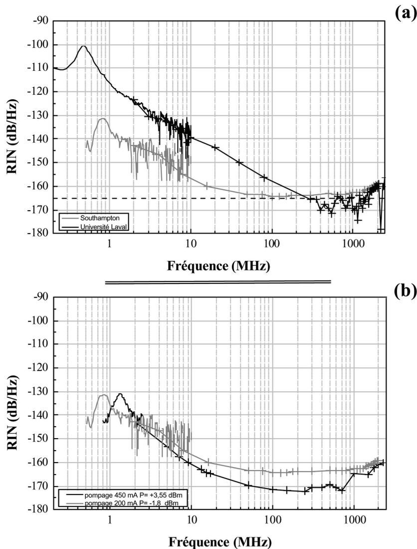
FIG. 3.25 – Mesures des bruits d'intensité des lasers monofréquences.
