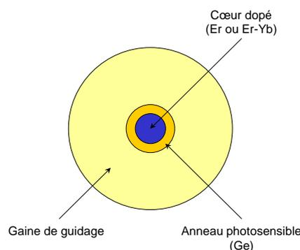
FIG. 3.1 – Structure transversale de la fibre INO.
