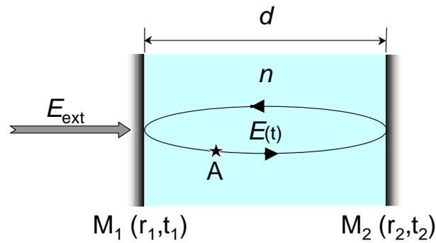
FIG. 8.1 – Description d'une cavité Fabry-Perot passive.
