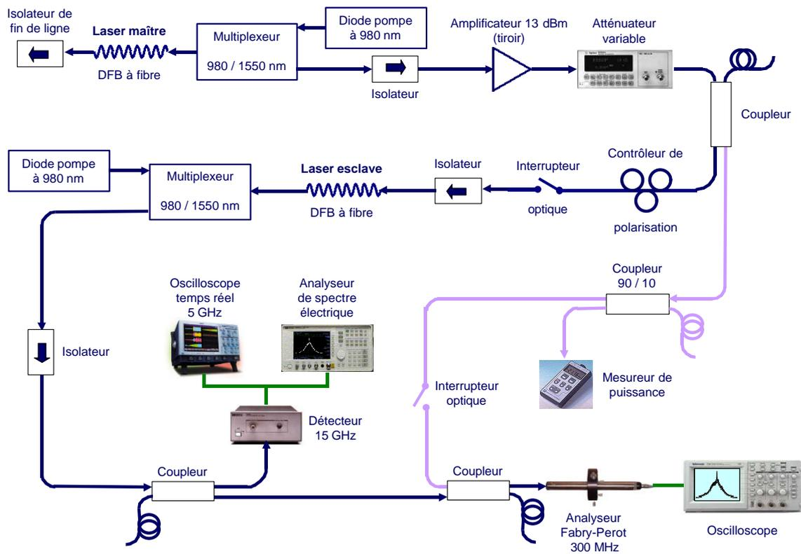
FIG. 7.1 – Montage expérimental pour l’injection des lasers à fibres.
