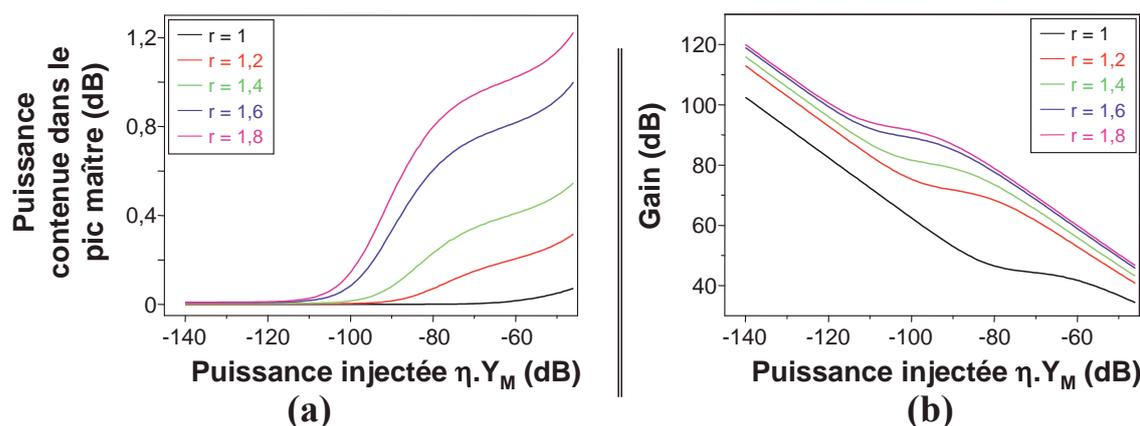
FIG. 9.3 – Défectivité et gain du laser détecteur.
