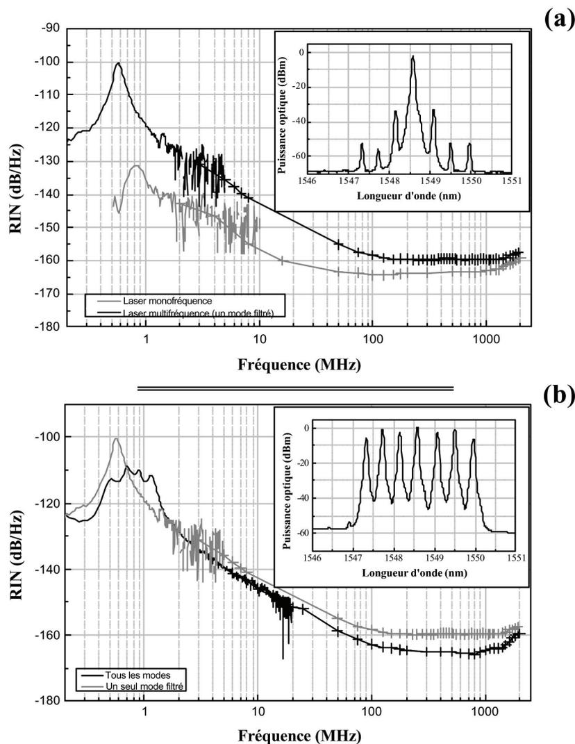
FIG. 3.26 – Mesures comparées des bruits d’intensité des lasers monofréquence et multifréquence. Les lignes continues bruitées de gauche sont déduites des mesures à l’analyseur de spectre électrique, les lignes continues marquées de croix sont les mesures utilisant la technique de mesure évoquée.
