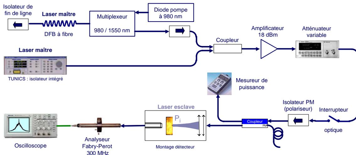
FIG. 5.3 – Montage expérimental pour la comparaison entre une injection faibles signaux d'un laser à semi-conducteurs par un laser à semi-conducteurs ou un laser à fibre.
