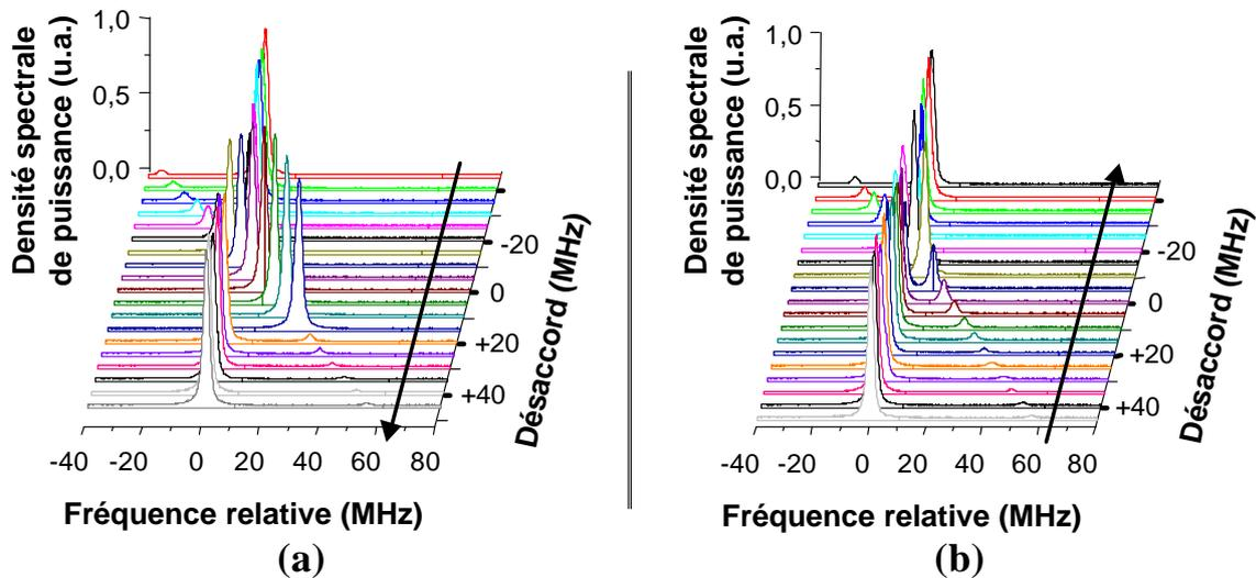
FIG. 6.5 – Spectres optiques de l'esclave injecté pompé près du seuil.
