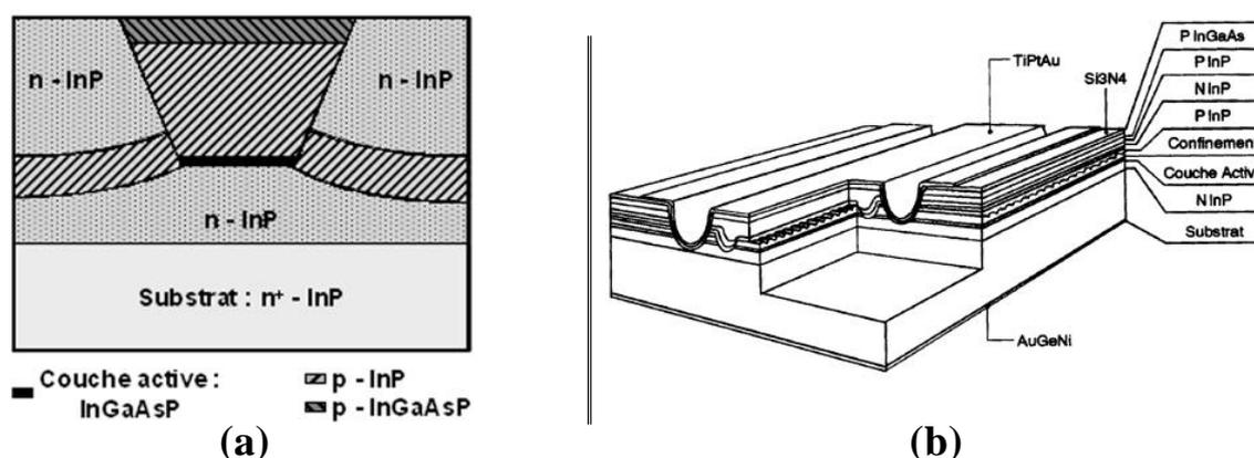
FIG. 2.1 – Description des puces lasers à semi-conducteurs utilisées.
