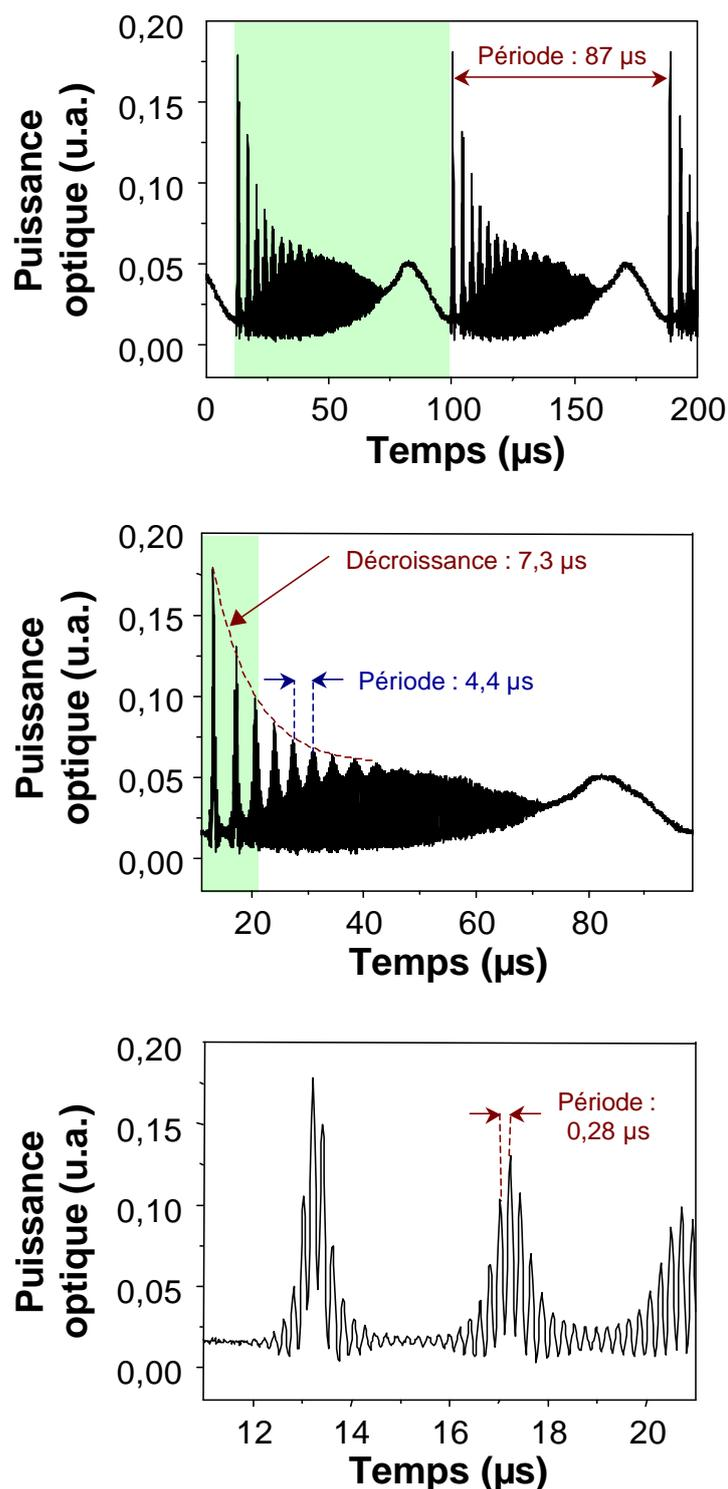
FIG. 7.4 – Détails d'une trace temporelle à l'accrochage progressif.
