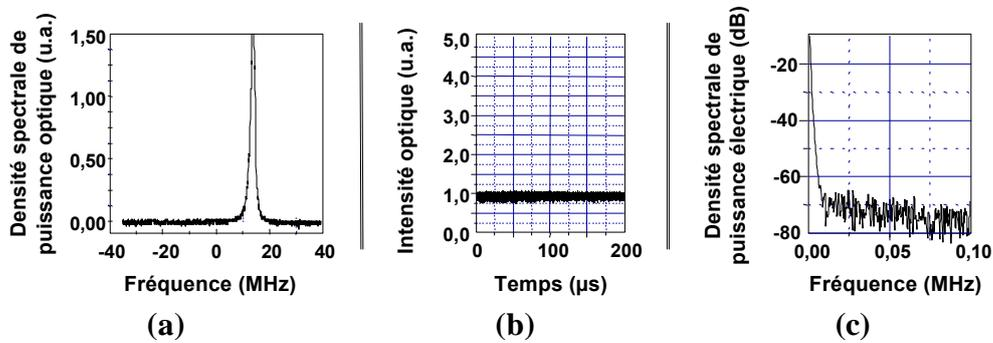
FIG. 6.9 – Comportement de l'esclave injecté à l'accrochage total.
