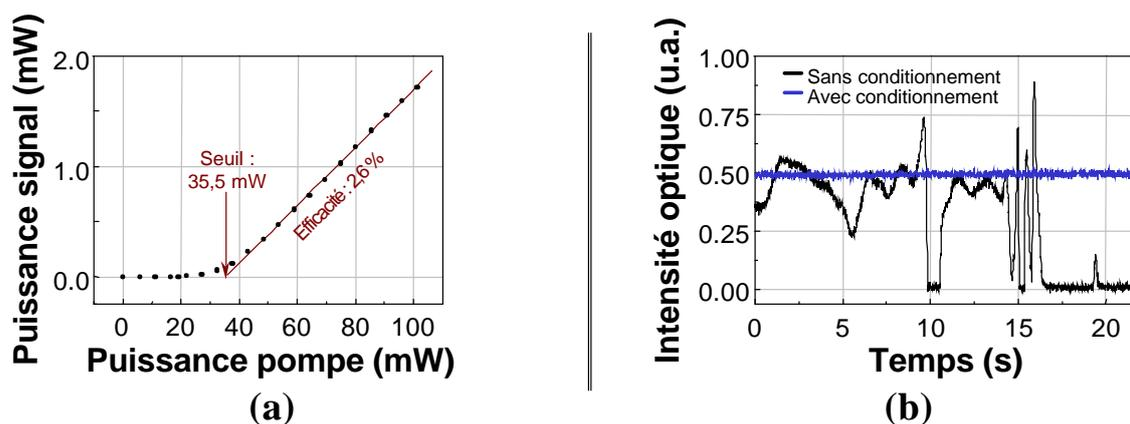
FIG. 3.15 – Caractérisation première des lasers à réflecteurs de Bragg répartis sur fibre codopée erbium-ytterbium.
