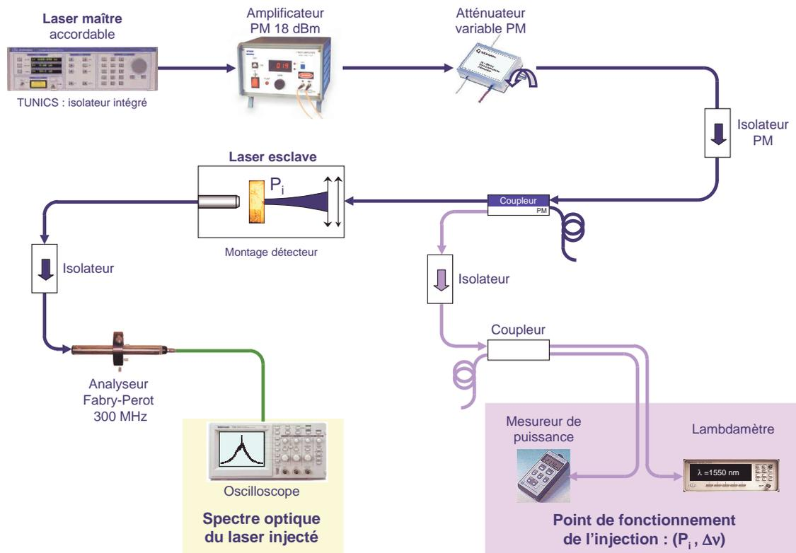
FIG. 4.21 – Montage expérimental de l'injection faible puissance.
