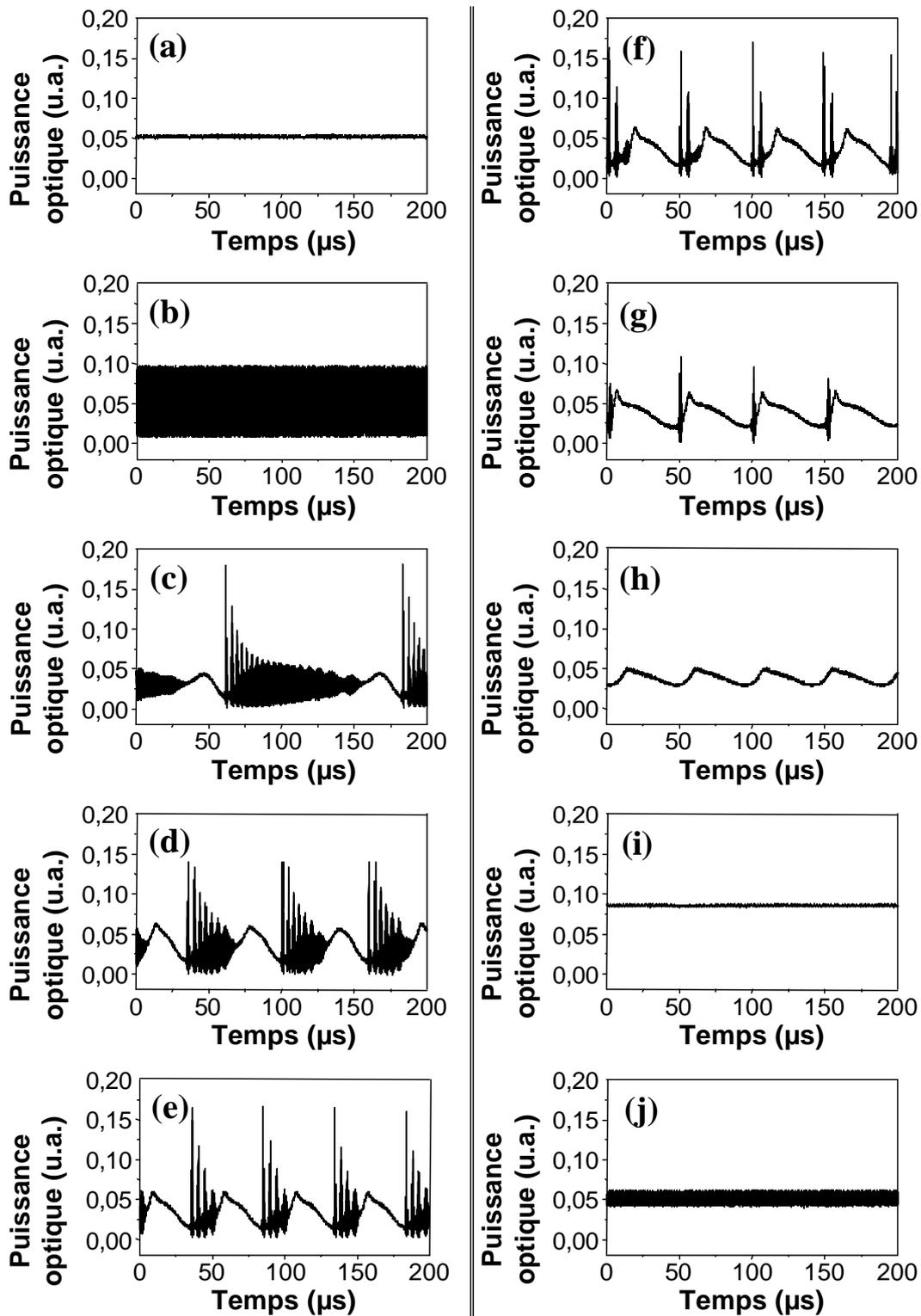
FIG. 7.3 – Comportement de l'esclave injecté à l'accrochage progressif.
