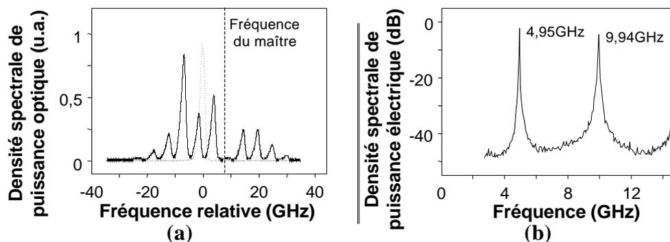
FIG. 4.5 – Spectres caractéristiques du mélange multi-ondes double.
