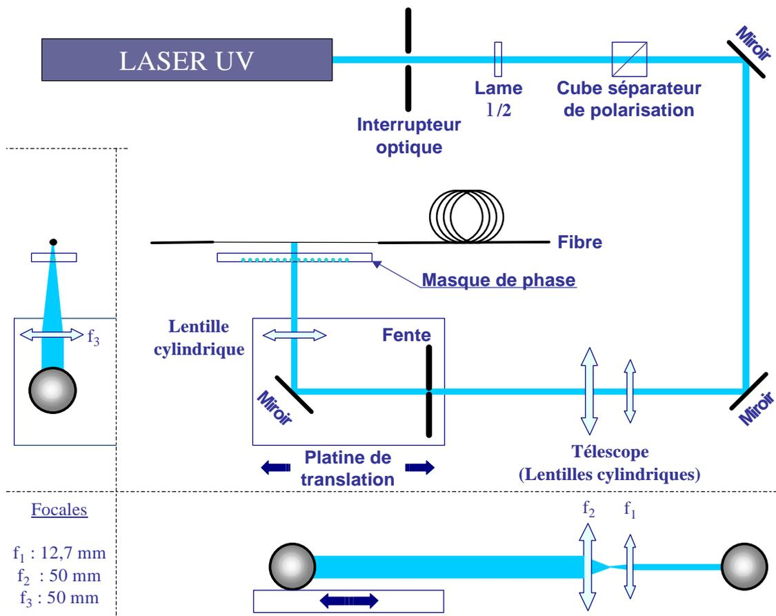
FIG. 3.7 – Montage expérimental d'inscription de réseaux de Bragg.
