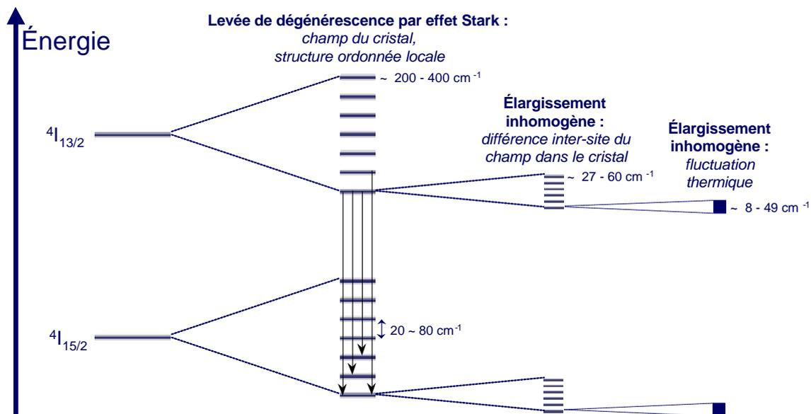
FIG. 3.4 – Dégénérescence des niveaux énergétiques de l'erbium.
