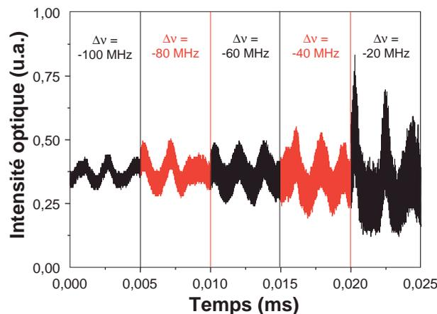
FIG. 6.13 – Allures temporelles de l'esclave injecté : battements modulés par la relaxation.
