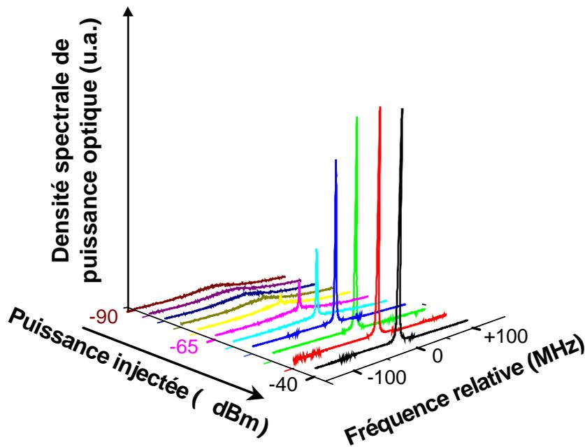
FIG. 4.23 – Évolution spectrale du laser faiblement injecté.
