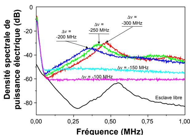
FIG. 6.14 – Spectres électriques de relaxation esclave versus désaccord.
