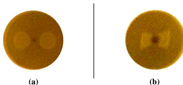
FIG. 4.2 – Photographies d'extrémités de fibres à maintien de polarisation.
