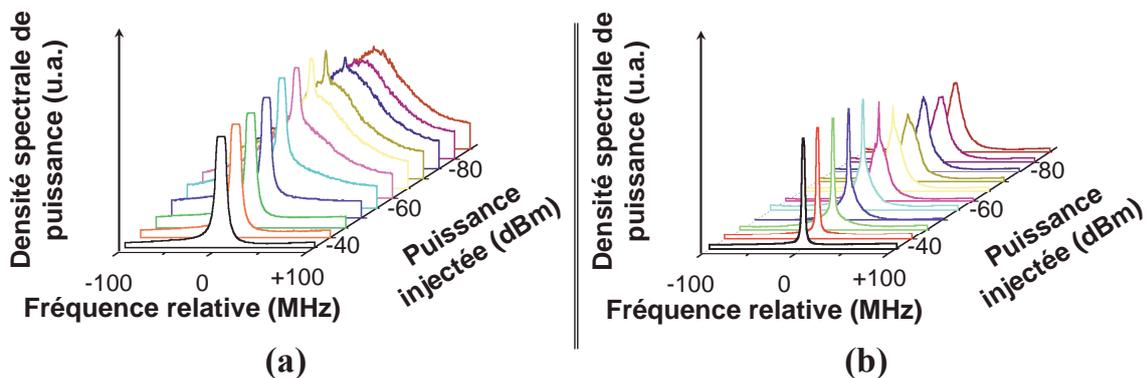
FIG. 4.25 – Piédestal du spectre du laser injecté.
