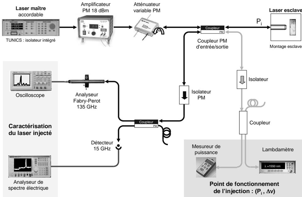
FIG. 4.8 – Montage expérimental pour les cartographies.
