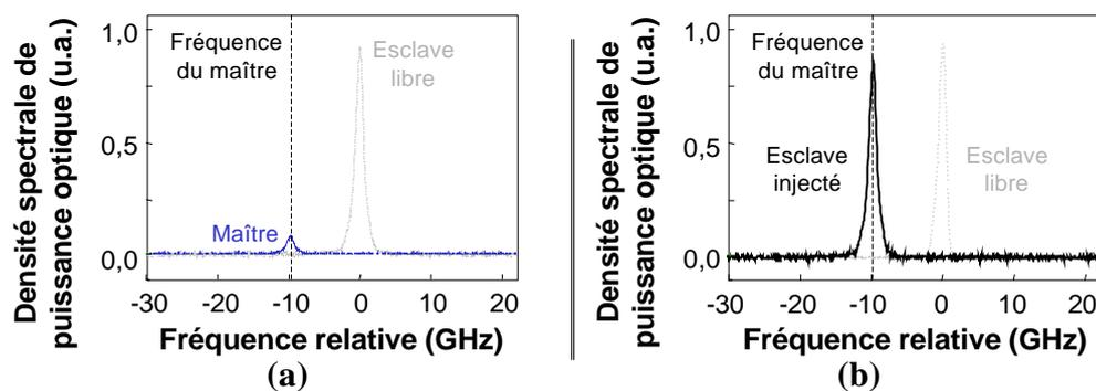
FIG. 4.3 – Spectres caractéristiques de l'accrochage en fréquence.
