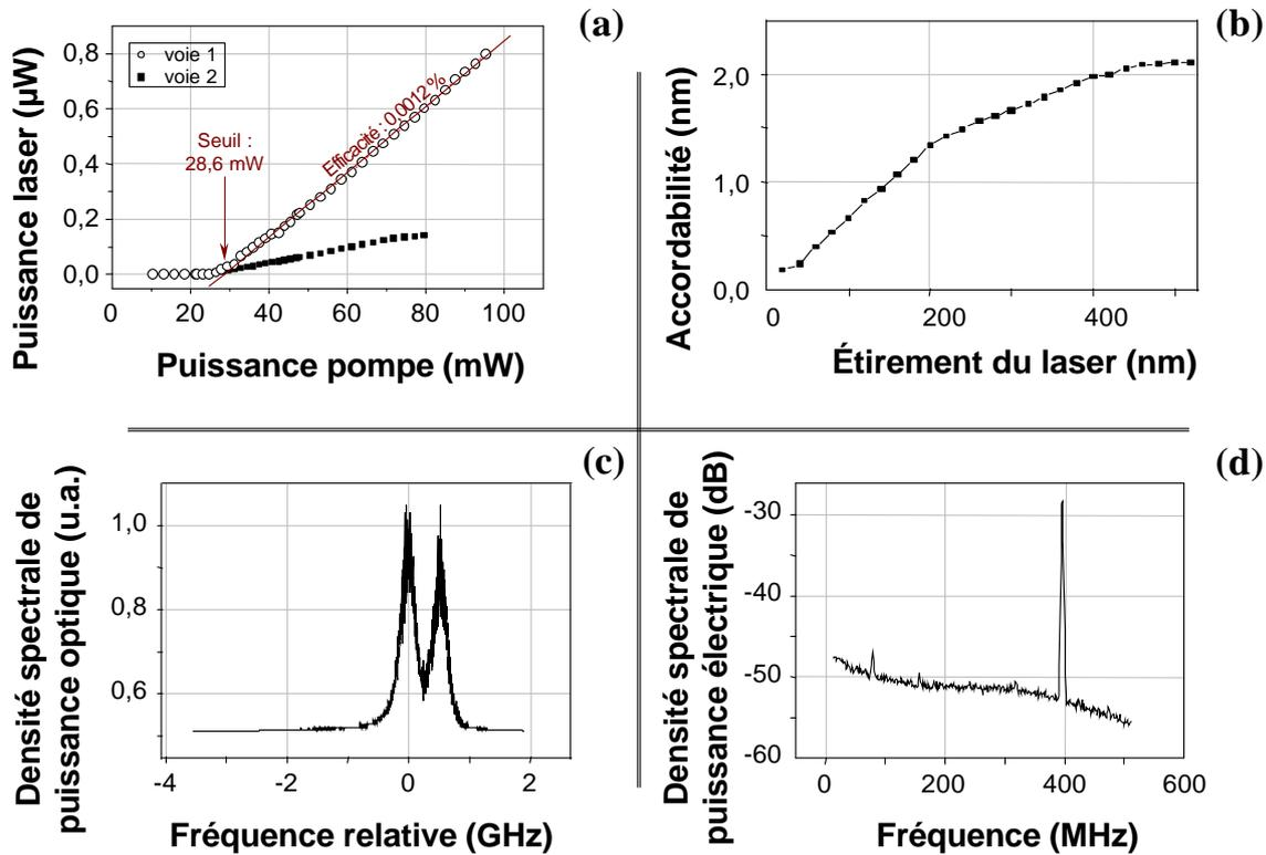
FIG. 3.12 – Caractérisation première des DBRs sur fibre erbium.
