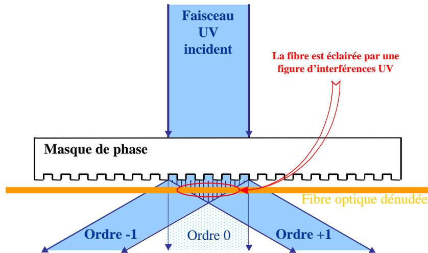
FIG. 3.8 – Principe du masque de phase pour la création d’une figure d’interférences.
