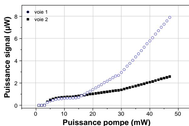
FIG. 3.13 – Influence du sens de pompage sur la caractéristique en puissance.
