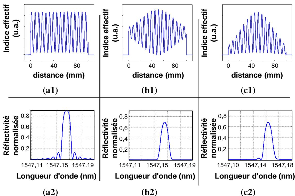
FIG. 1.4 – Différents profils d'apodisation de réseaux de Bragg.
