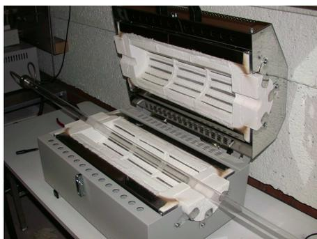
FIG. 3.1 – Le montage de la croissance CVD et en particulier le four
