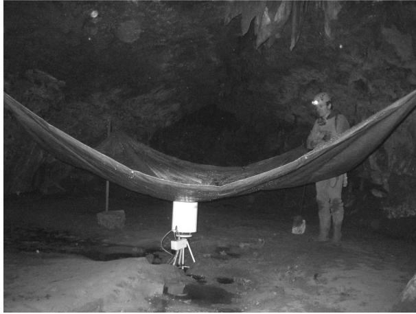
Figure 9.5 : Installation du pluviomètre au fond de l'aven de la Beaumelle. Une bâche collectrice est visible sous les stalactites.
