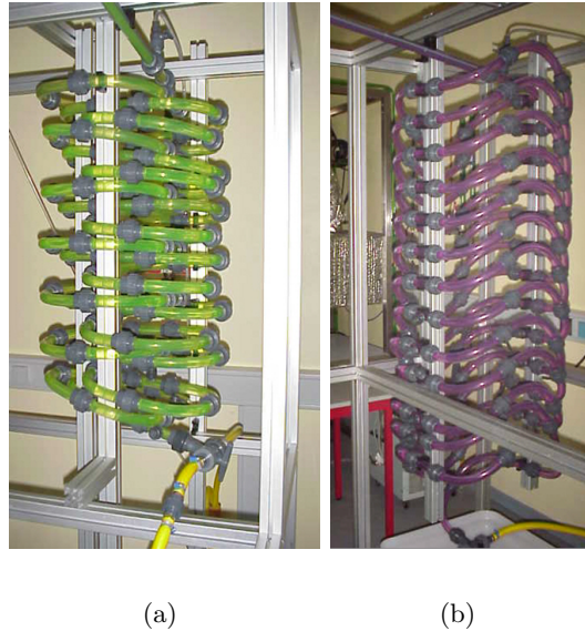
FIG. 3.3: Photos montrant les deux serpentins mélangeur-réacteur. 3.3(a) Serpentin hélicoïdal et 3.3(b) serpentins à trajectoires chaotiques.
