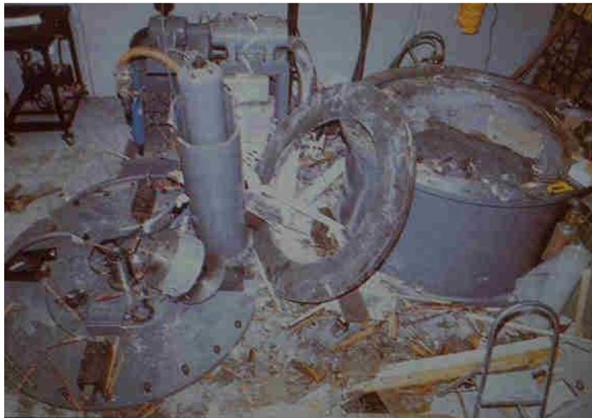
Figure I - 9 : Crash d'un système d'accumulation d'énergie électromécanique
