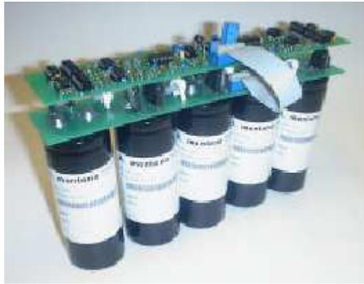
Figure I - 4 : Banc de super capacités
