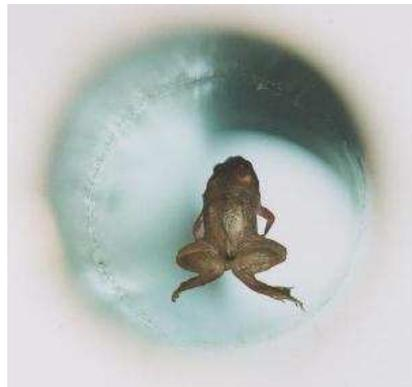
Figure II - 5 : Exemple de lévitation d'un corps diamagnétique [WEB01]
