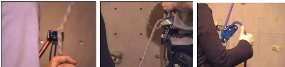
*Photo 20: Des systèmes d'assurage différents (un puits, un reverso, un grigri)*
