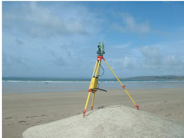
FIG. 3.14 – Tachéomètre laser LEICA.
