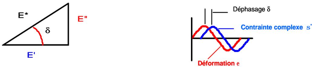
Figure 7. Mesure dynamique des propriétés mécaniques
