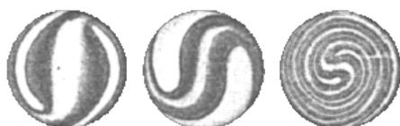
FIGURE 1.2 – Dessin des gouttes qui s'enroulent et tournent sous l'action du flux de chaleur [Lehoo].
