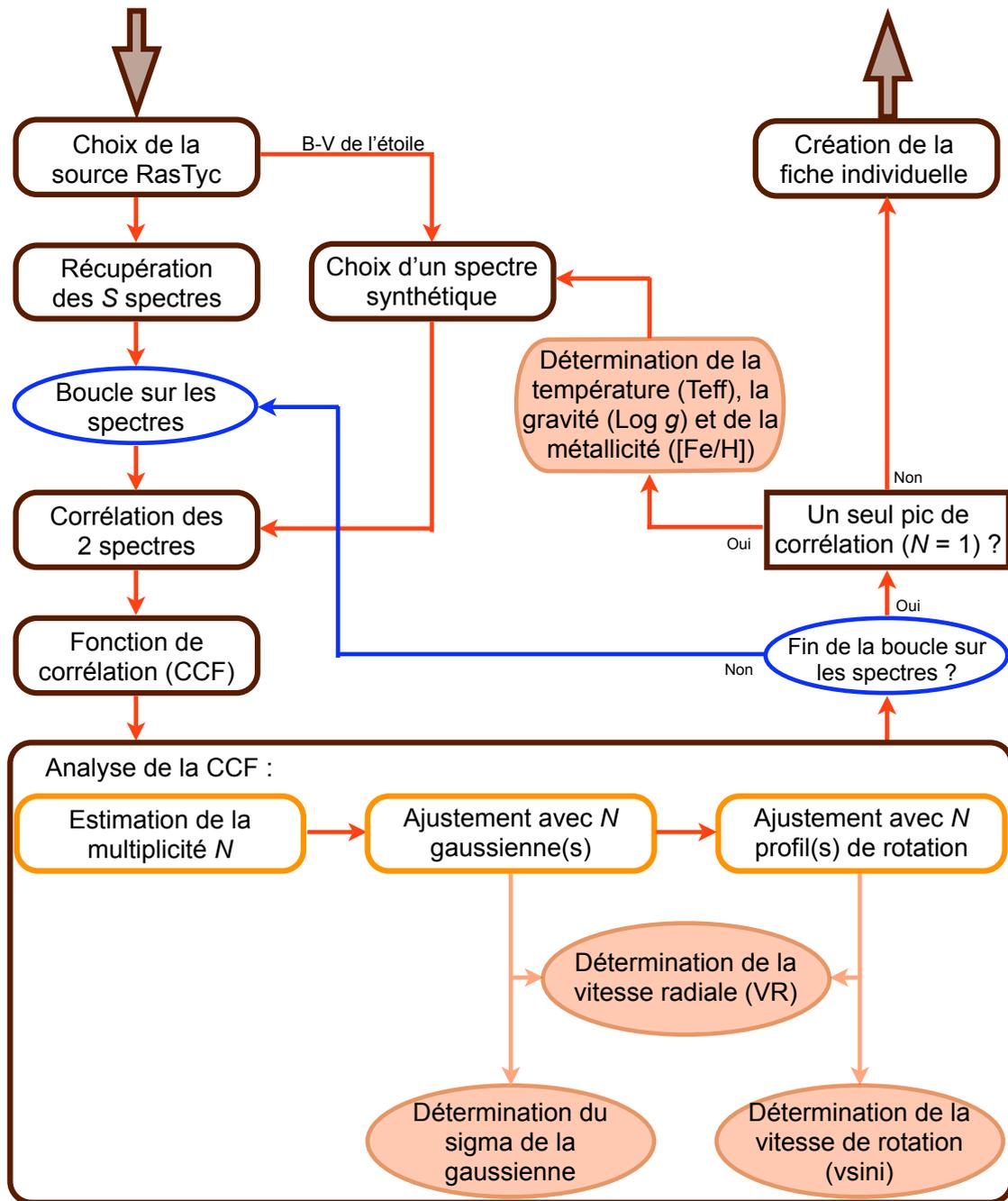
FIG. II.1 – Schéma illustrant les différentes étapes de la procédure utilisée pour analyser les spectres d’une source *RasTyc* donnée afin d’extraire un maximum d’informations sur ses paramètres stellaires.
