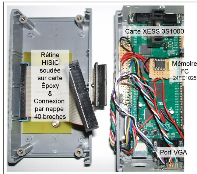
FIG. B.1 – Illustration photographique de l'intérieur du système de vision
