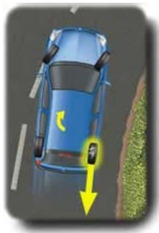
*Figure 11. Exemple de déclenchement de l'ESP lorsque le véhicule est en situation de sous-virage.*
