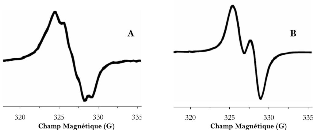
Figure I-10 : spectres RPE (9 GHz) du radical tyrosyle formé par irradiation en milieu basique (solution congelée). A : Tyr entièrement hydrogénée. B : 3,5- $^2\text{H}$ -Tyr. tiré de Hulsebosch *et al.*, référence 111
