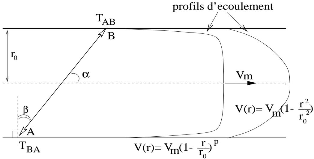
FIG. 2.2 – Principe du débitmètre à ultrasons. Profils d’écoulement en régime turbulent et laminaire.
