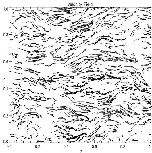
FIG. 2.5 – Exemple d'écoulement fluide bidimensionnel turbulent de vitesse moyenne  $\mathbf{v}_0 = (10 \text{ m/s}, 0 \text{ m/s})$ . Perturbations de vitesse à spectre de Kolmogorov pour chaque composante de la vitesse :  $L_0 = 0.2 \text{ m}$ ,  $l_0 = 0.002 \text{ m}$ , écart types  $\sigma_{v_1} = \sigma_{v_2} = 5 \text{ m/s}$ . Les unités des axes sont en mètres.
