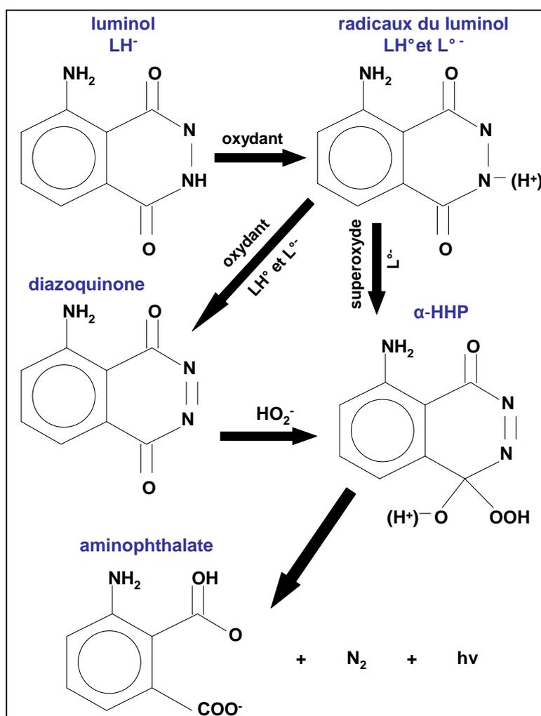
Figure 10 : Mécanisme réactionnel d'oxydation du luminol.
