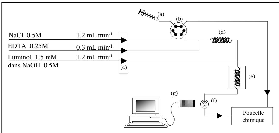
**Figure 9** : Schéma des différents montages en FIA-CL : (a) seringue d'injection, (b) vanne d'injection, (c) pompe péristaltique, (d) bobine de mélange (e) bain thermostaté (f) cellule de lecture, (g) photomultiplicateur.
