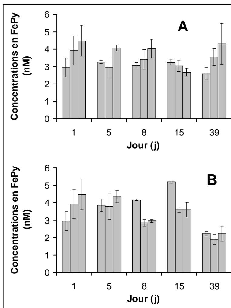
**Figure 16** : Stabilité de la chimiluminescence des échantillons naturels (eau du Rhône) en fonction du temps. Les échantillons sont non filtrés et empoisonnés au  $HgCl_2$ . Deux modes de stockage sont testés: (A) à température ambiante (B) après congélation.
