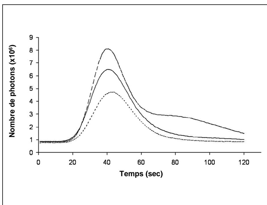
**Figure 13** : Modification des signaux obtenus selon la nature du fluide porteur : eau milli-Q (grand pointillé), solution de chlorure de sodium 0,5 M (continu) ou eau de mer artificielle (petit pointillé). Les pics ont été obtenus en injectant un standard d'hémine à 6 nM réalisé dans de l'eau de mer.
