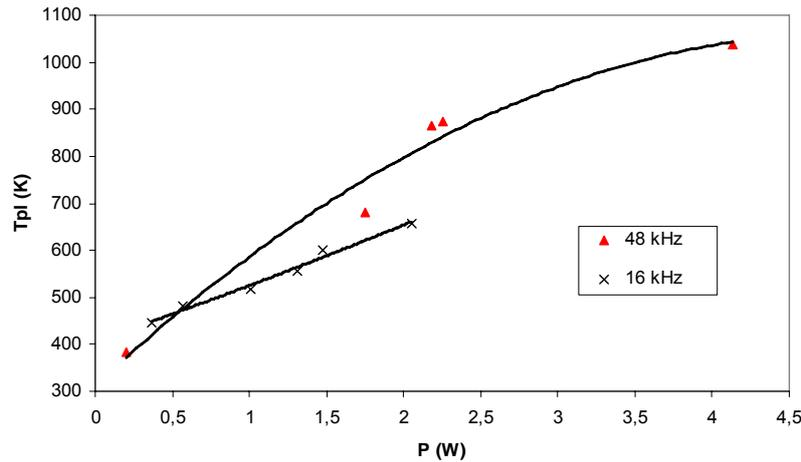
Figure 11. Températures de plasma  $T_{pl}$  comparée pour deux fréquences de tension sinusoïdale appliquée à la pointe Réacteur pointe-plan,  $d = 2$  mm, diélectrique  $\text{SiO}_2/\text{Al}_2\text{O}_3$ , air sec  $D = 100$  L/h.
