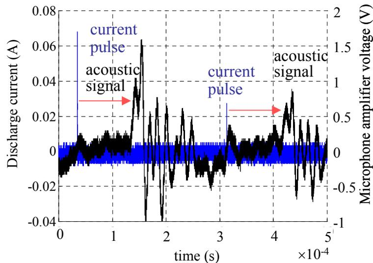
Figure 12. Signal de courant de décharge et signal acoustique associé. Décharge en air ambiant, tension crête 6,4 kV,  $F = 3,5$  kHz. Rapport d'amplification du microphone :  $A_p$  (Pa) = 2,61 x microphone voltage amplif. (V)
