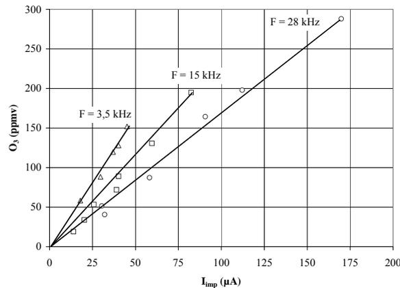
Figure 5. Concentration en ozone obtenue dans l'effluent de décharge en fonction du courant impulsionnel pour différentes fréquences de pulsation ; réacteur pointe-plan,  $d = 2$  mm, diélectrique  $\text{SiO}_2/\text{Al}_2\text{O}_3$ , air sec,  $D = 100$  L/h, signal de tension pulsé.
