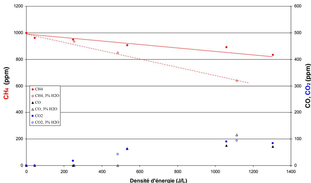
Figure 18. Oxydation du méthane par procédé plasma froid à pression atmosphérique en présence ou absence de vapeur d'eau (3% Vol.). Réacteur DBD, D = 2 L/min, P : 0-70 W [Thèse A. Mfopara].
