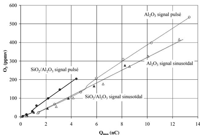
(c) réacteur pointe-plan,  $d = 0 \text{ mm}$ , diélectrique  $\text{SiO}_2/\text{Al}_2\text{O}_3$  et  $\text{Al}_2\text{O}_3$ , air sec  $D = 100 \text{ L/h}$ , signal de tension sinusoïdal 16 kHz et pulsé à 16 kHz
