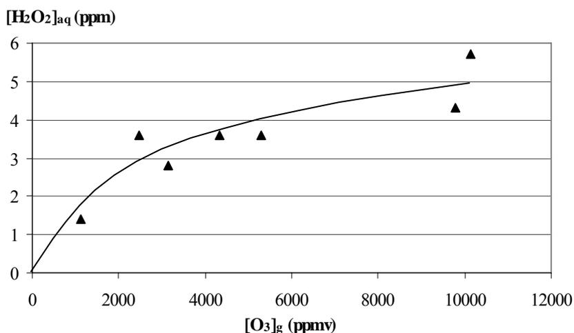
Figure 23. Concentration de H<sub>2</sub>O<sub>2</sub> obtenue dans la phase aqueuse collectrice en fonction de la concentration en ozone dans le gaz, durée de l'exposition : 20 minutes
