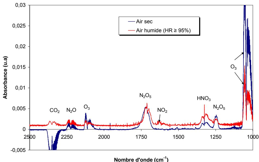
Figure 19. Spectre FTIR d'effluent de décharge en « air sec » ( $\text{HR} \leq 5\%$ ) et air humide ( $\text{HR} \geq 95\%$ ). Réacteur DBD pointe-plan ;  $d=2$  mm,  $D=0,5$  L/min,  $V_{\text{crête}}=6,5$  kV,  $F=48$  kHz.
