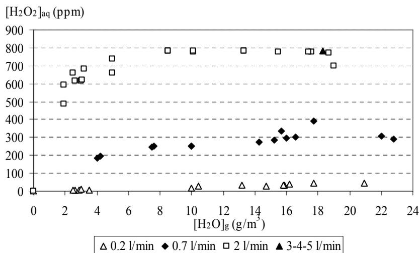
Figure 26. Concentrations de  $H_2O_2$  mesurées en phase aqueuse en fonction de la concentration en vapeur d'eau dans l'argon, à différents débits (0,2 – 0,7 – 2 – 3 – 4 – 5 L/min). Réacteur 2,  $P = 1,5 W$ , 10 minutes d'exposition.
