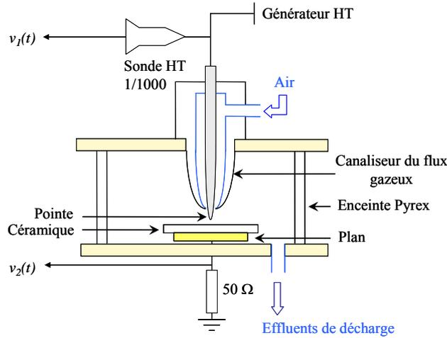
Figure 1. Cellule de décharge utilisée pour l'étude. Pointe inox d'un rayon de courbure de 50 µm. Plan laiton recouvert d'une plaque Al<sub>2</sub>O<sub>3</sub> ou SiO<sub>2</sub>/ Al<sub>2</sub>O<sub>3</sub> de 3 mm d'épaisseur. Intervalle gazeux séparant l'extrémité de la pointe de la surface de l'isolant : 0-2 mm.
