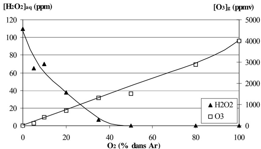
Figure 22. Concentrations de peroxyde d'hydrogène mesurée en phase aqueuse (dans des gouttes de 10  $\mu$ l) et d'ozone mesurée en phase gazeuse en fonction de la composition du gaz contenant un mélange Ar / O<sub>2</sub> / H<sub>2</sub>O, à [H<sub>2</sub>O]<sub>g</sub> constante ; réacteur 1 à décharges de surface, débit = 0,2 l / min, P = 1,7 W, 20 minutes exposition.
