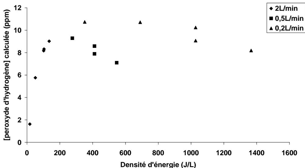
Figure 28. Concentrations de  $H_2O_2$  dans l'effluent gazeux de décharge calculées à partir des mesures en phase aqueuse, en fonction de la densité d'énergie, pour différents débits. Réacteur 2, 10 minutes d'exposition.
