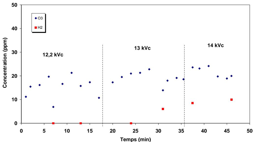
Figure 21. Production d'ozone et d'hydrogène par une décharge pointe-plan DBD en air humide (HR  $\geq$  95%).
