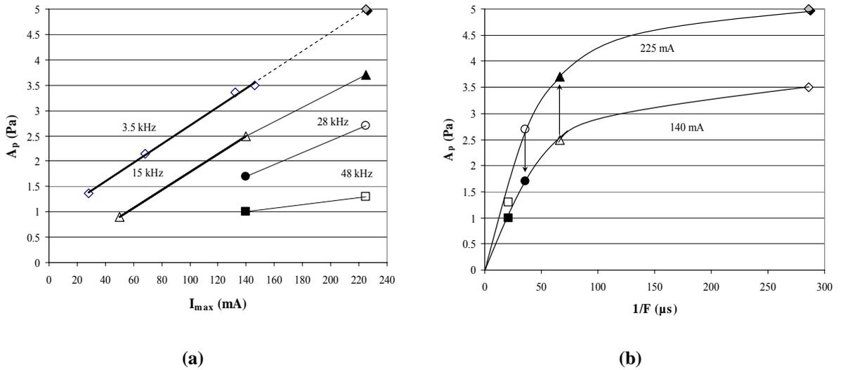
Figure 13. Amplitude de l'onde acoustique  $A_p$  en fonction (a) de l'amplitude des impulsions de courant  $I_{max}$  et (b) du temps de relaxation ( $1/F$ ) entre deux impulsions successives. Point blancs : des résultats expérimentaux ; points noirs de la figure (a) déduits de la figure (b).
