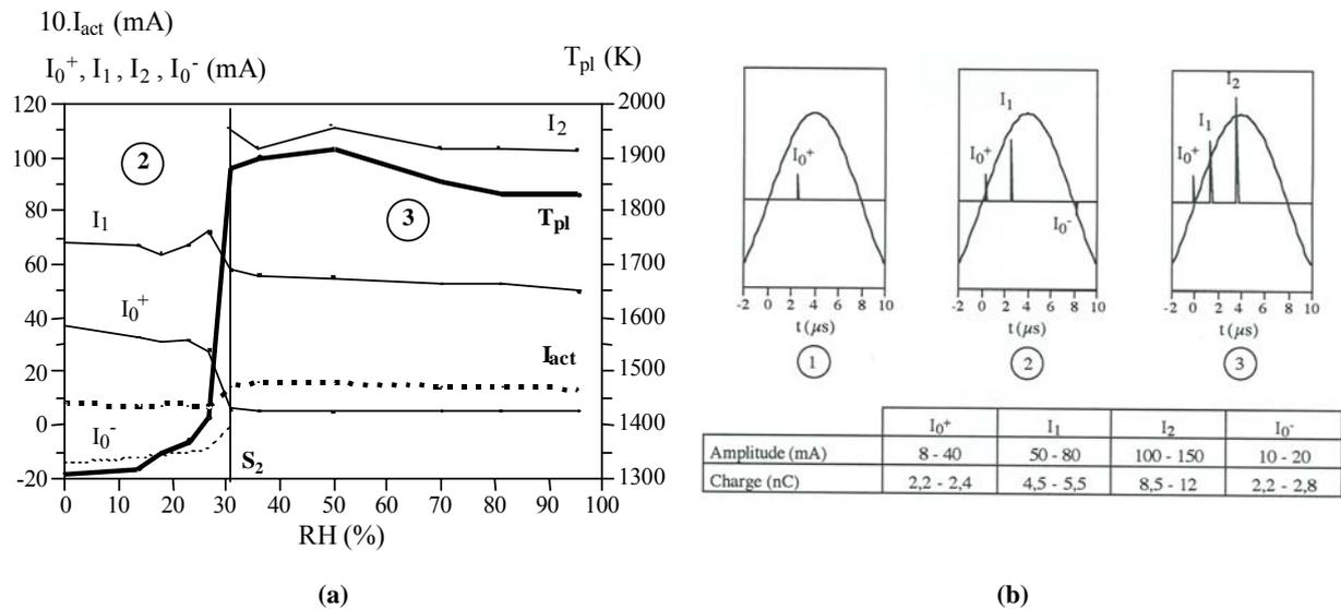
Figure 10. Evolution du courant actif de décharge  $I_{act}$  et de ses composantes impulsionnelles ainsi que de la température de plasma  $T_{pl}$  en fonction de l'humidité relative. Réacteur pointe-plan, tension appliquée sinusoïdale 63 kHz d'amplitude constante (8,75 kV crête).  $d=6$  mm, diélectrique  $SiO_2/Al_2O_3$ , air sec  $D = 60$  L/h. [P-4]
