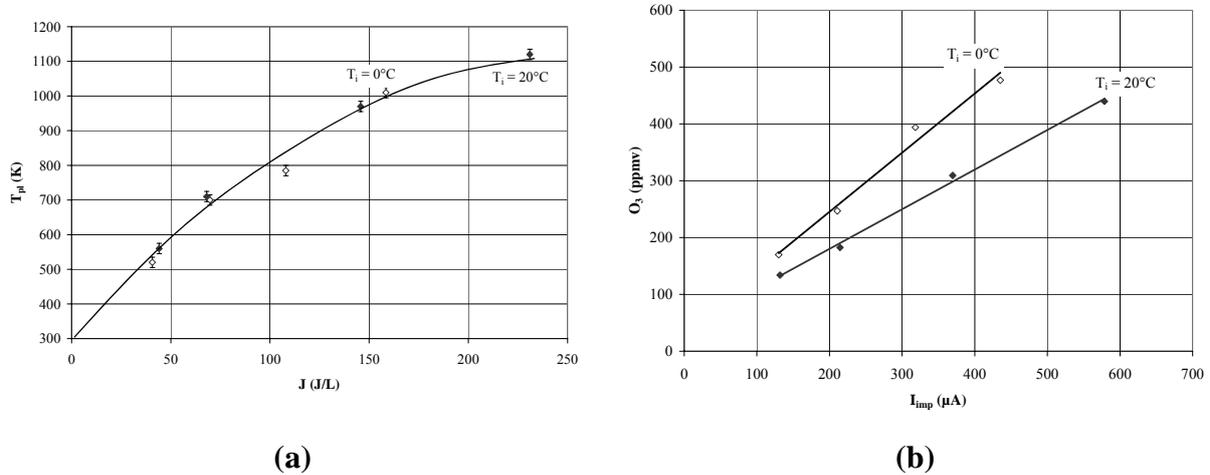
Figure 16 : Evolutions comparée entre gaz à température ambiante et gaz à  $0^\circ\text{C}$  (a) de la température de plasma en fonction de la densité d'énergie, (b) de la production d'ozone en fonction du courant impulsionnel. Réacteur pointe-plan,  $\text{SiO}_2/\text{Al}_2\text{O}_3$ ,  $d = 2$  mm, air sec,  $D = 100$  L/h,  $F = 48$  kHz, signal de tension sinusoïdal.
