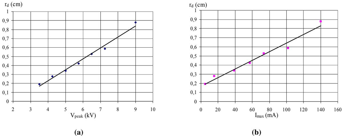
Figure 8. Rayon de propagation (rayon du disque lumineux) formé autour du point triple en fonction (a) de la tension appliquée (valeur crête  $V_{peak}$ ) et (b) de l'amplitude maximum des impulsions de courant  $I_{max}$ . Réacteur pointe-plan,  $d=0$  mm, diélectrique  $SiO_2/Al_2O_3$ , air sec  $D = 100$  L/h, signal de tension sinusoïdal 16 kHz.
