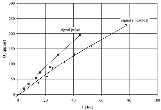
(c) réacteur pointe-plan,  $d = 2$  mm, diélectrique  $\text{SiO}_2/\text{Al}_2\text{O}_3$ , air sec,  $D = 100$  L/h, signal de tension pulsé à 15 kHz ou sinusoïdal 15 kHz
