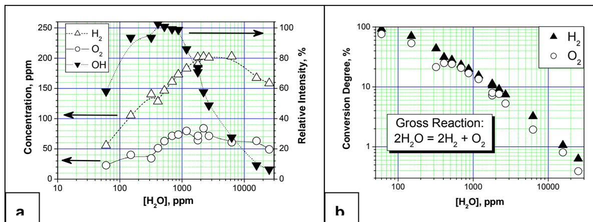
Figure 30. Influence de la concentration en vapeur d'eau de l'argon sur (a) l'émission du radical  $\text{OH}^*(A^2\Sigma^+)$  et la production d'hydrogène et d'oxygène et (b) le taux de conversion de la vapeur d'eau en ces espèces stables. Réacteur 2 modifié, débit total de 2 L/min, P=3 W [P-38].
