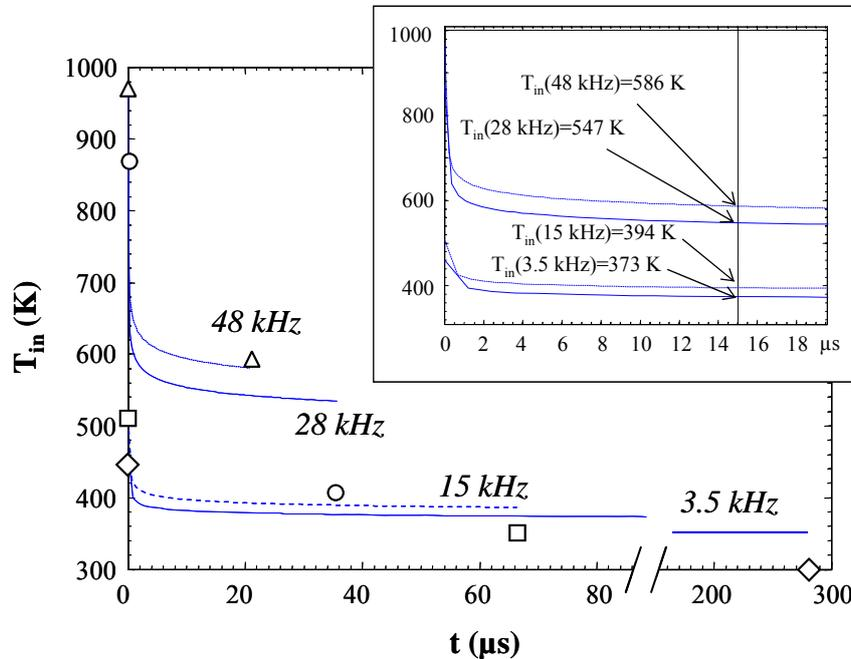
Figure 14. Déclin de température après passage du streamer ( $t=0$ ) en fonction du temps de relaxation. Points expérimentaux (obtenus pour  $I_{max}=225$  mA) et simulation numérique par méthode de différences finies (lignes).
