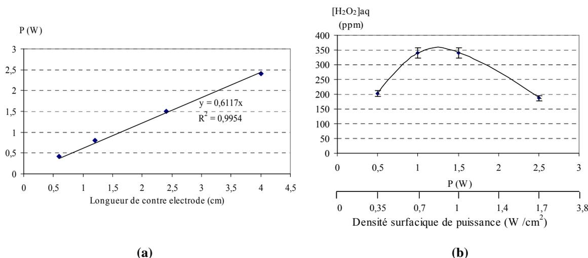
Figure 24. (a) Puissance en fonction de la longueur de contre-électrode pour une même tension crête appliquée  $V_c = 2,75$  kV, (b) concentration de  $H_2O_2$  en fonction de la puissance et de la densité surfacique de puissance, exposition 10 minutes, réacteur 2 mélange Ar /  $H_2O$  ;  $D=0,7$  L /min.
