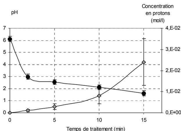
Figure 20. Acidification de gouttes d'eau au contact des effluents d'une décharge couronne dans un mélange gazeux O<sub>2</sub>/N<sub>2</sub> = 20/80 pour différentes durées de traitement [Thèse S. Delaveau]
