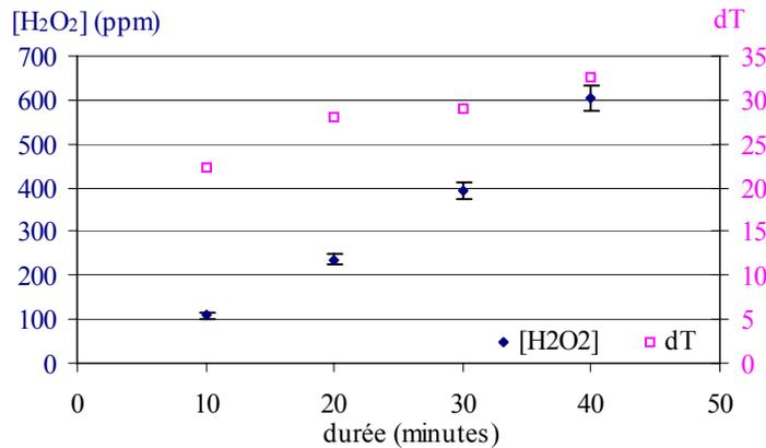
Figure 25. Concentration de  $H_2O_2$  obtenue dans un film d'eau de 4 ml et variation de la température  $dT$  de la contre électrode en fonction de la durée de l'expérience. Réacteur 2, mélange Ar /  $H_2O$ ,  $P = 2,6 W$  (longueur de contre électrode : 4cm), débit = 2 l/min.
