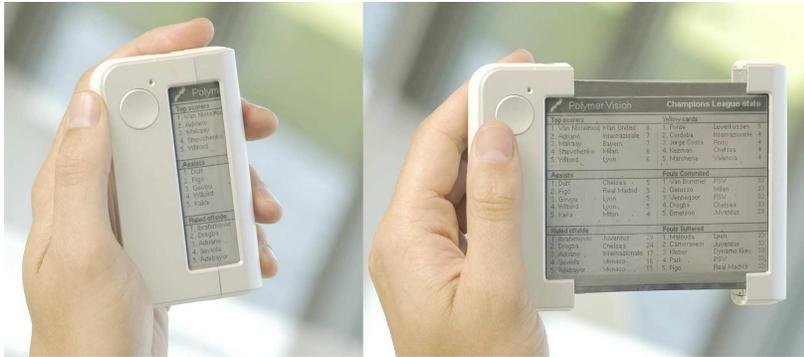
FIGURE 1.4 – Polymer Vision propose des affichages électroniques souples et enroulables, vers l'e-volumen ?
