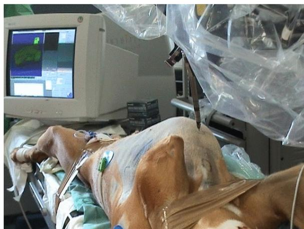
FIG. 7.6 – *Recalage externe par pointage des marqueurs à l'aide du robot.*
