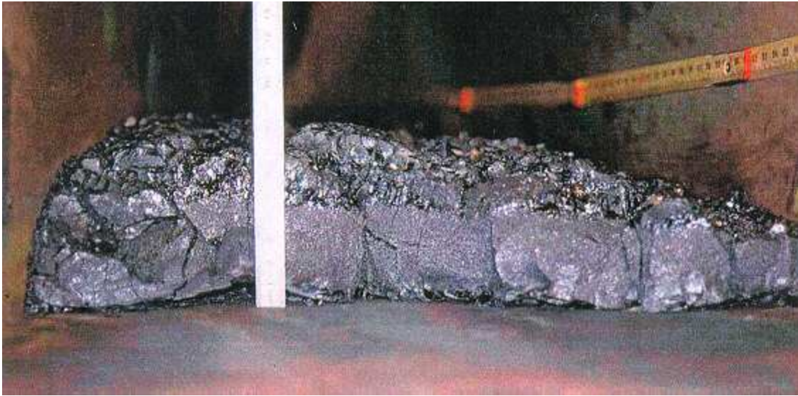
Figure 2-13 : Coupe de la coulée de corium FARO L26-S (d'après Cognet et al. , 2001)
