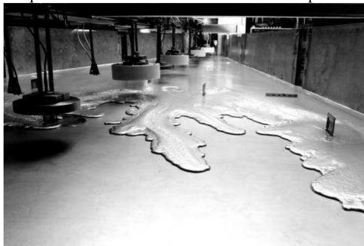
Figure 2-4 : Coulée d'un alliage métallique dans la veine d'étalement CORINE. Noter les capteurs de niveau, au-dessus du plan d'étalement.
