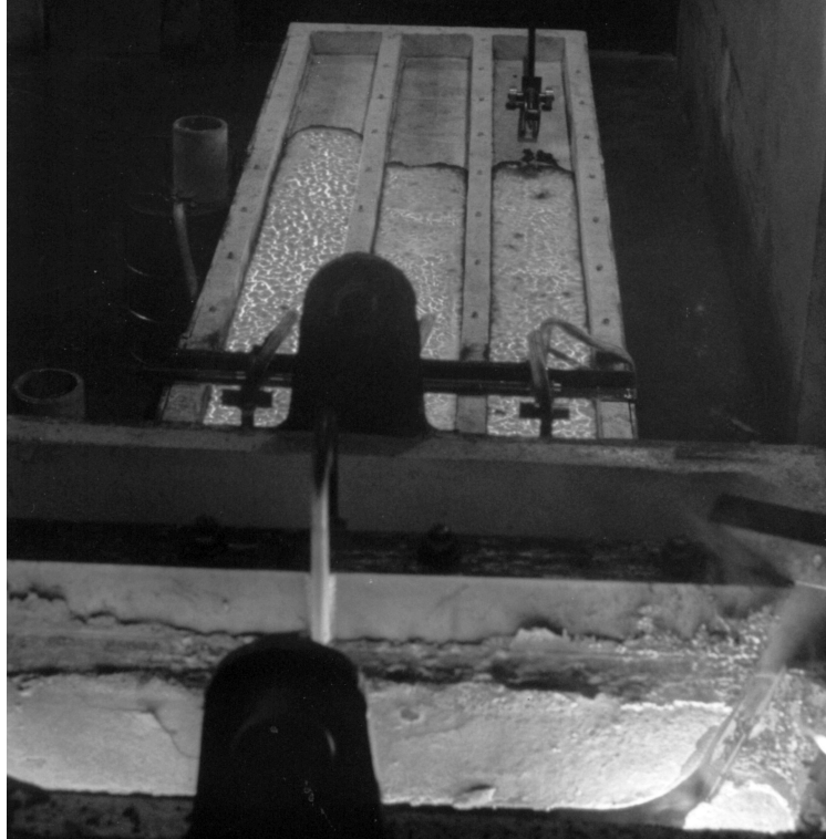
Figure 2-12: Essai COMAS EU-2B d'étalement sur trois substrats différents.
