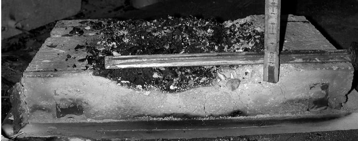
Figure 3-20 : Béton avec agrégats siliceux-20% calcaire ablaté par l'(U,Zr)O 2 lors de l'essai VE-U8 Au maximum, 2 cm ont été ablatés.
