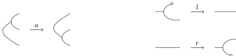
Cette représentation par diagrammes de cordes nous permet de décrire les lois de cohérence par des petits « films » décrivant la déformation des morphismes structuraux. Par exemple, le film de gauche de la Figure 3.1 indique que les deux façons que l'on a de passer d'une association à gauche à une association à droite sont identiques.
