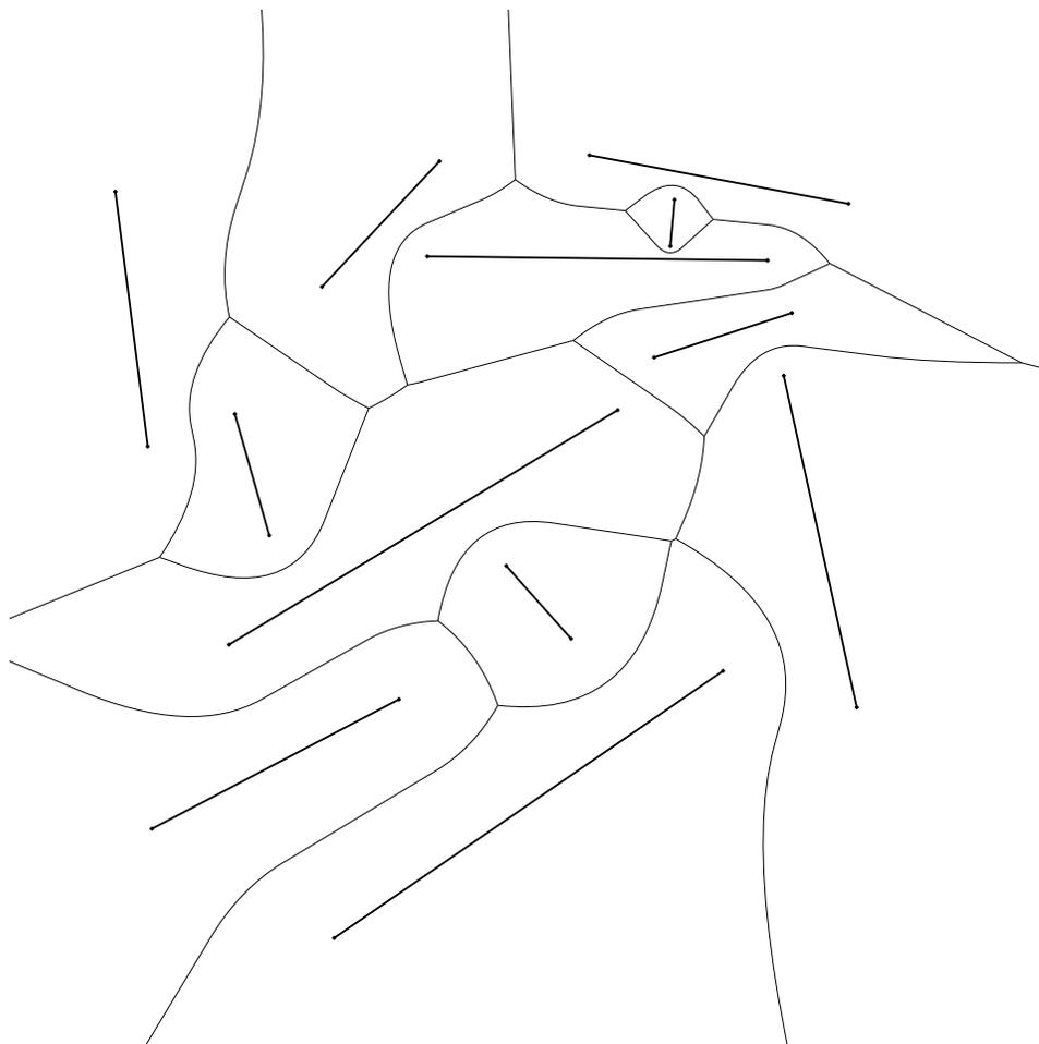
FIG. I.9 – Exemple de diagramme de Voronoï de segments
