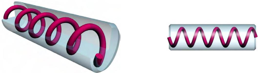
Figure 3.1 : Lit régénérateur monotube en serpent.
