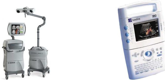
FIG. 4.2 – A gauche : le Système de neuronavigation StealthStation TREON Medtronic. Dans notre étude ce système est équipé du système SonoNav permettant le suivi et l'acquisition de la position de la sonde ainsi que la sauvegarde des images ultrasonores. Au droit : l'échographe Sonosite 180 Plus couplé à une sonde crânienne 4 – 7MHz lors des acquisitions en salle.
