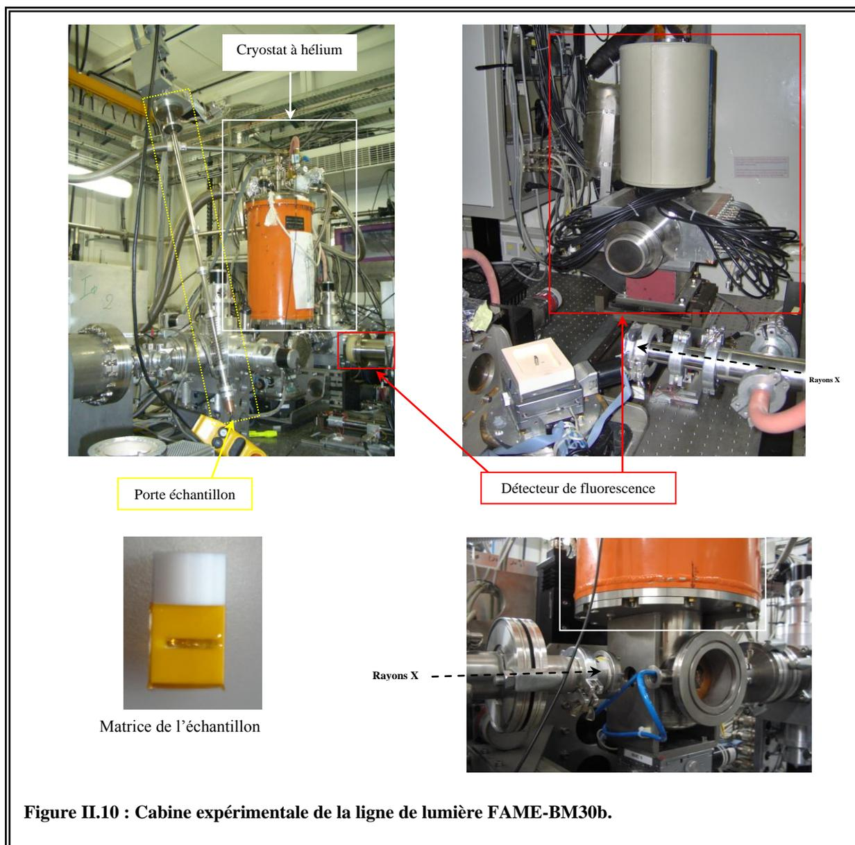
Figure II.10 : Cabine expérimentale de la ligne de lumière FAME-BM30b.
